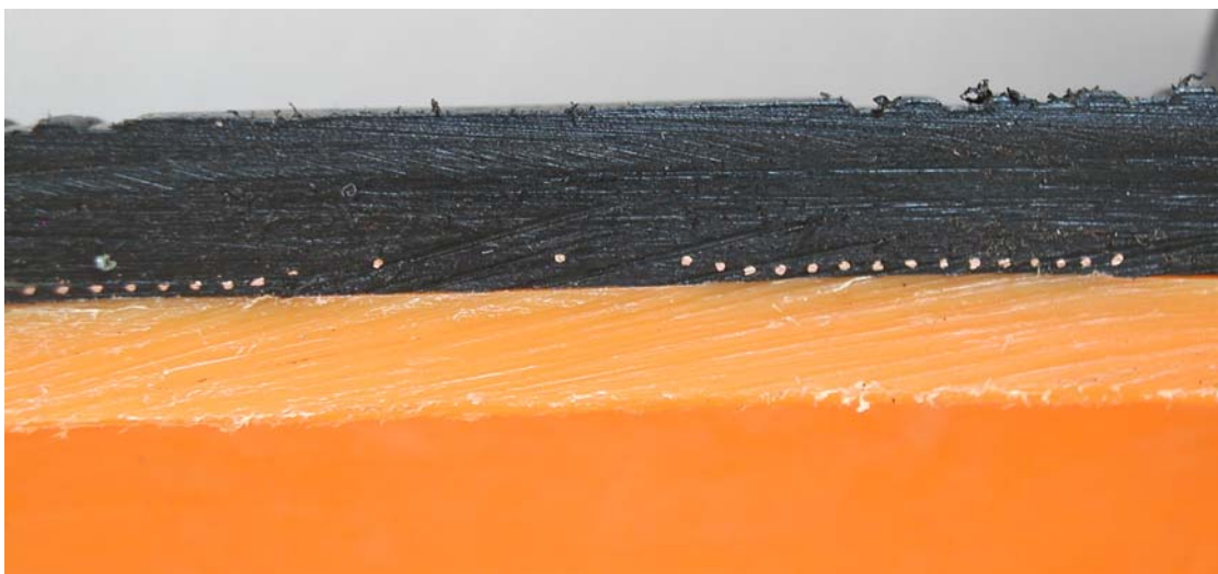
Slika 6. Detalj elektrofuzijskog zavarenog spoja u presjeku
