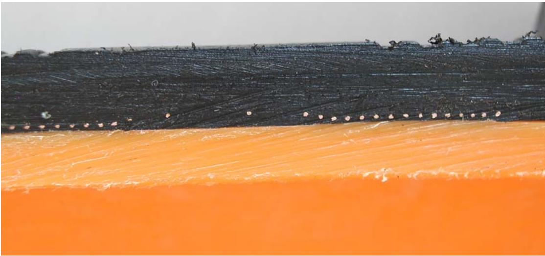
Slika 6. Detalj elektrofuzijskog zavarenog spoja u presjeku
