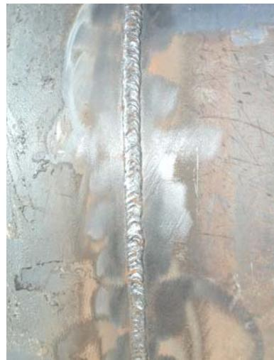
Slika 8. Izgled zavarenog spoja sa strane lica zavara izveden silaznom REL tehnikom zavarivanja uz korištenje celulozne elektrode.
