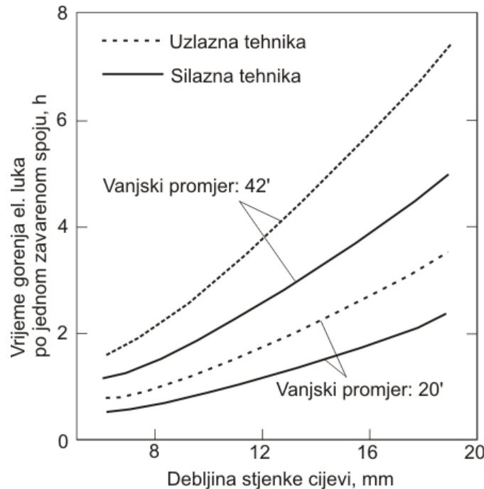
Slika 2. Trajanje gojenje el. luka kod zavarivanja čeličnih cijevi uz primjenu elektroda sa niskim sadržajem vodika, a za primjenjenu silaznu i uzlaznu tehniku zavarivanja. [2]
