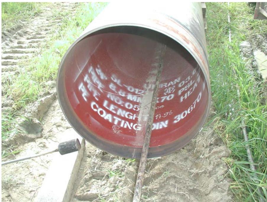
Slika 3. Čelična plinovodna cijev (X70) promjera 24' i debljine stjenke 8.8 mm.
