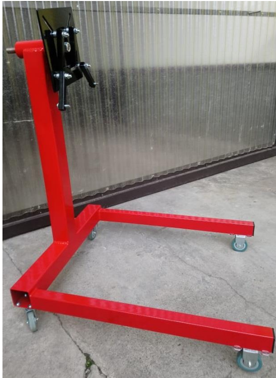
Figure 14. Konačna izvedba nosača motora
