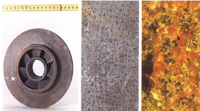
Slika 2.12 Korozija selektivnog tipa [18]
