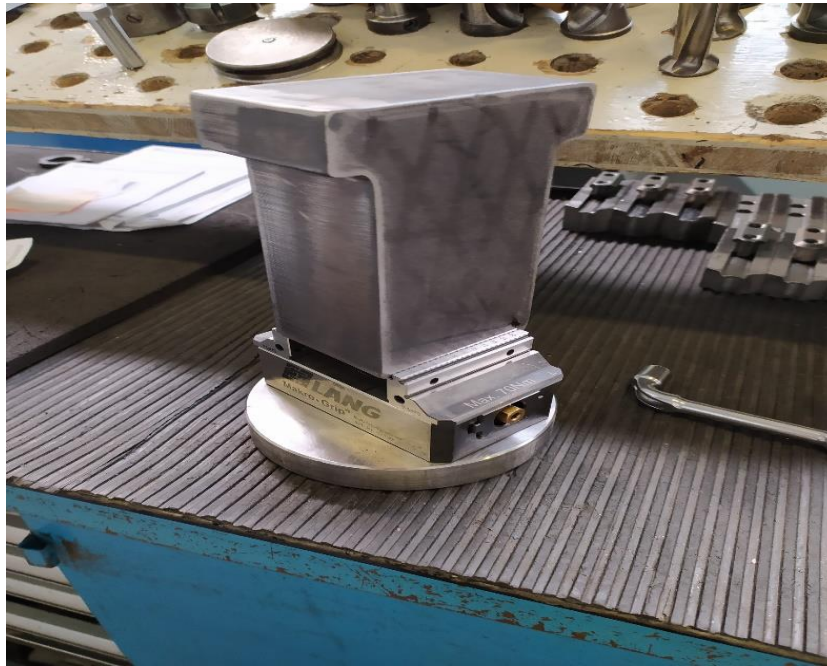
Slika 3.31 Sirovac stegnut u petoosni škrip [11]
