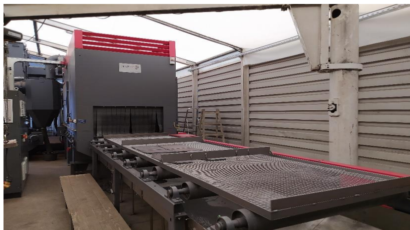
Slika 3.5 Gostol tip 1000x600 za sačmarenje [11]
