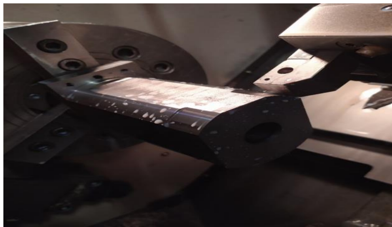
Slika 3.39 Vanjsko grubo i fino tokarenje alatom MVJNR 2525M16 [11]
