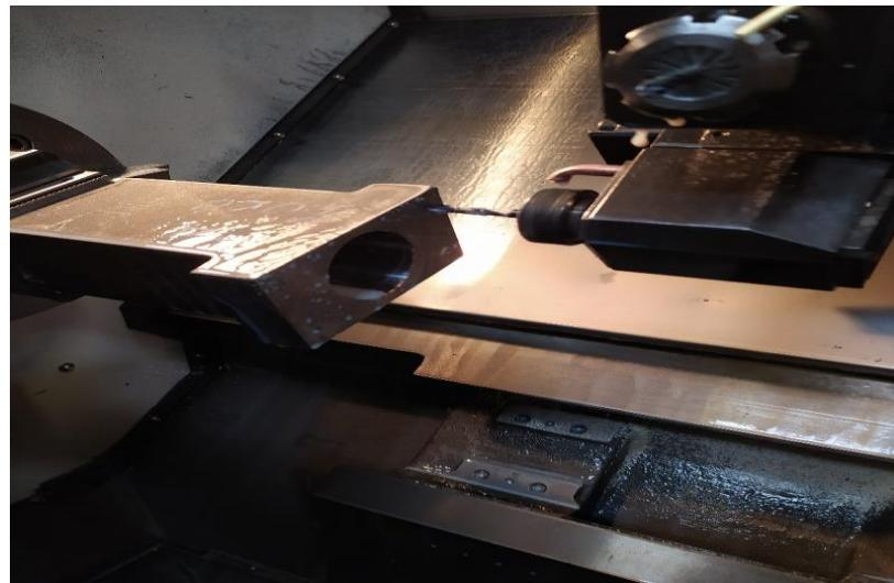
Slika 3.36 *Bušenje provrta  $\text{fi}8\text{H}7$  i  $\text{fi}9\text{mm}$*  [11]
