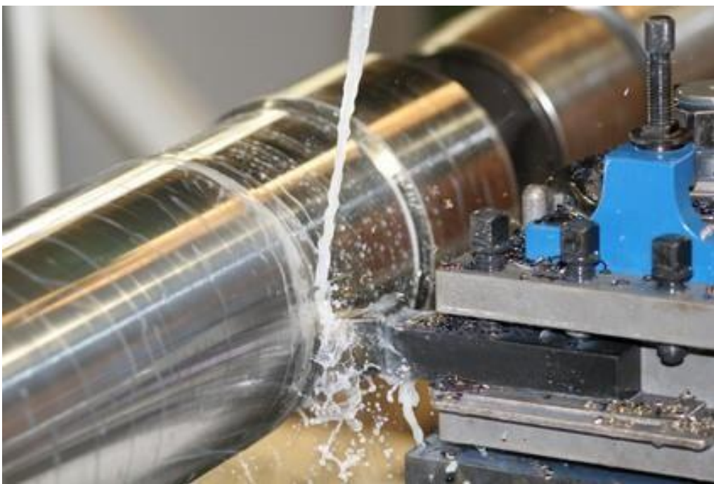
Slika 1.15 Tokarenje s vanjskom primjenom SHIP-a [7]
