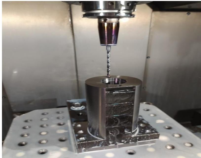
Slika 3.57 Bušenje provrta i rupa M5 [11]
