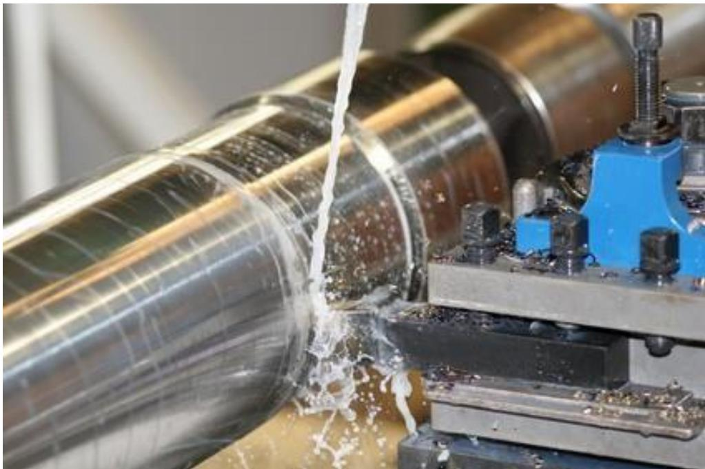
Slika 1.15 Tokarenje s vanjskom primjenom SHIP-a [7]
