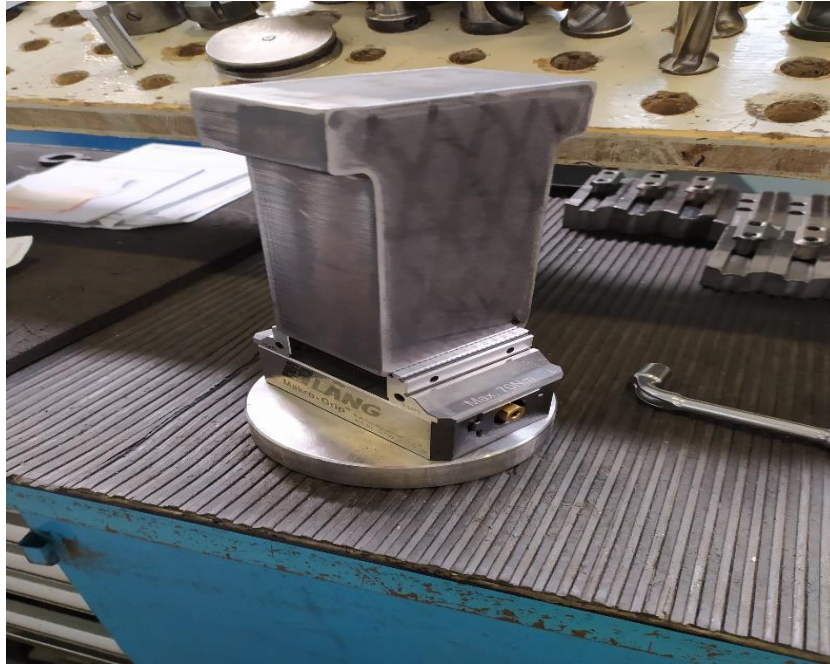
Slika 3.31 Sirovac stegnut u petoosni škrip [11]
