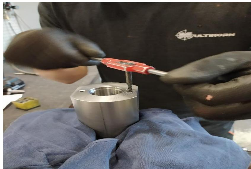
Slika 3.59 Ručno urezivanje navoja M5 prema crtežu [11]
