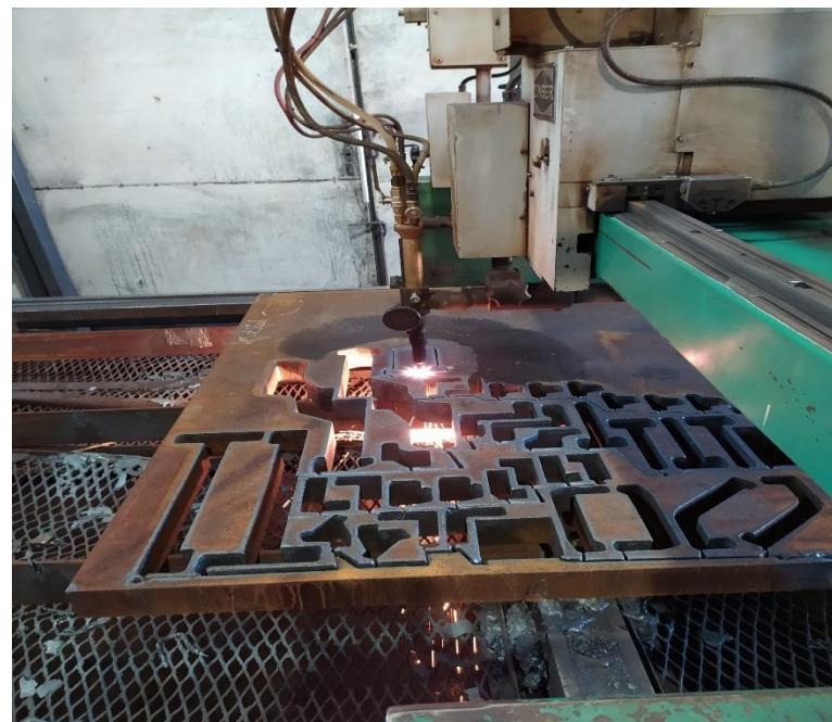
Slika 3.3 Plinsko izrezivanje na Zinser CNC 500/E [11]
