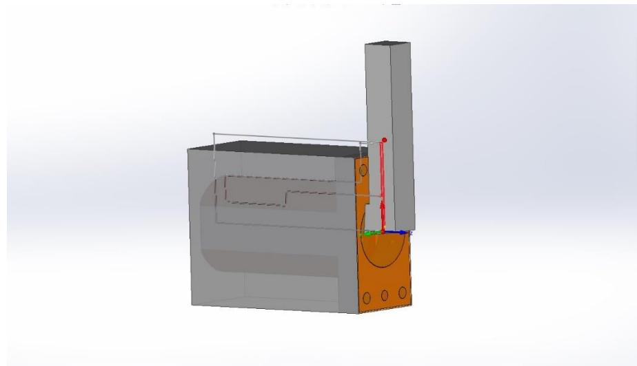
Slika 3.6 SOLIDCAM simulacija čeonog grubog poravnjanja [11]
