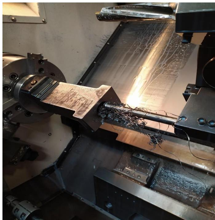
Slika 3.35 Tokarski nož za unutarnje tokarenje S32U PCLNR12 L=125 [11]
