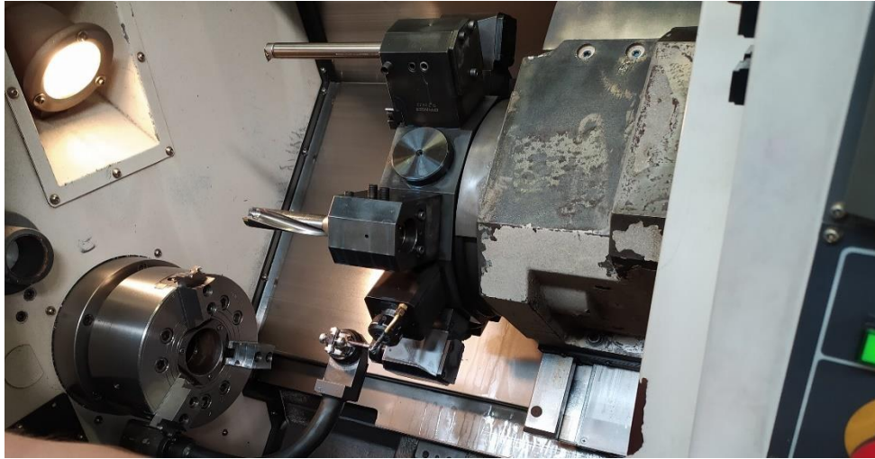
Slika 3.32 Umjeravanje svakog alata i stezanje škripa u čeljusti [11]
