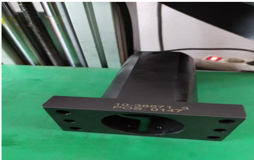
Slika 3.63 Lasersko gravinje serijskog broja pozicije [11]
