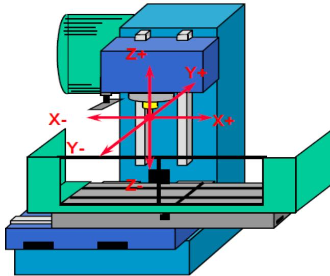
Slika 1.17 *Položaj osi kod vertikalnog obradnog centra* [6]
