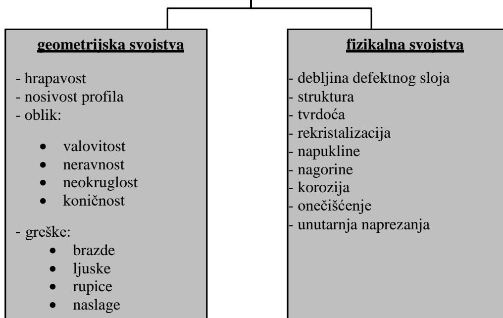
Slika 1.14 *Kvaliteta obrađene površine* [10]
