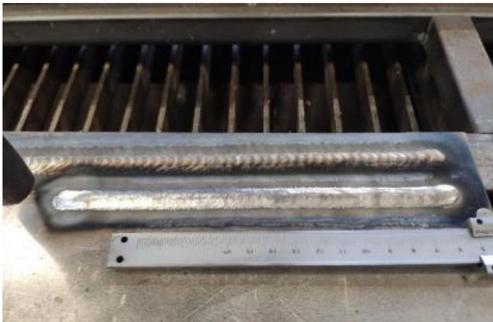
Slika 4.8 Navarivanje postupkom običnog MIG pulsa i duplog pulsa [22]
