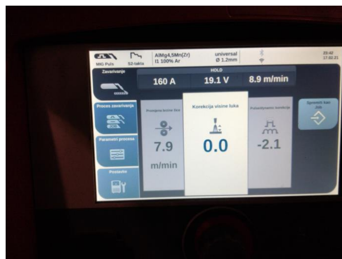
Slika 4.6 Podešavanje visine luka zavarivanja [21]
