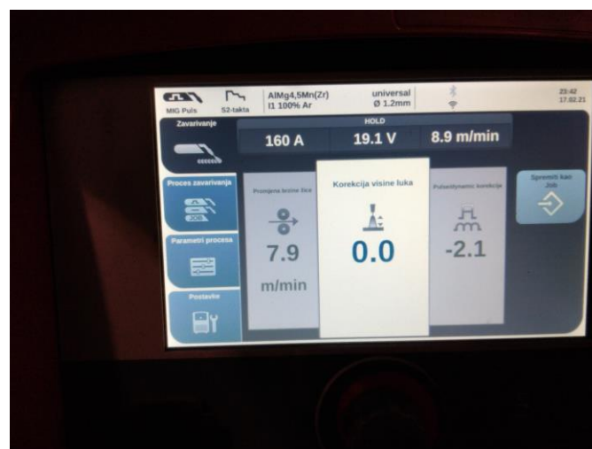
Slika 4.6 Podešavanje visine luka zavarivanja [21]
