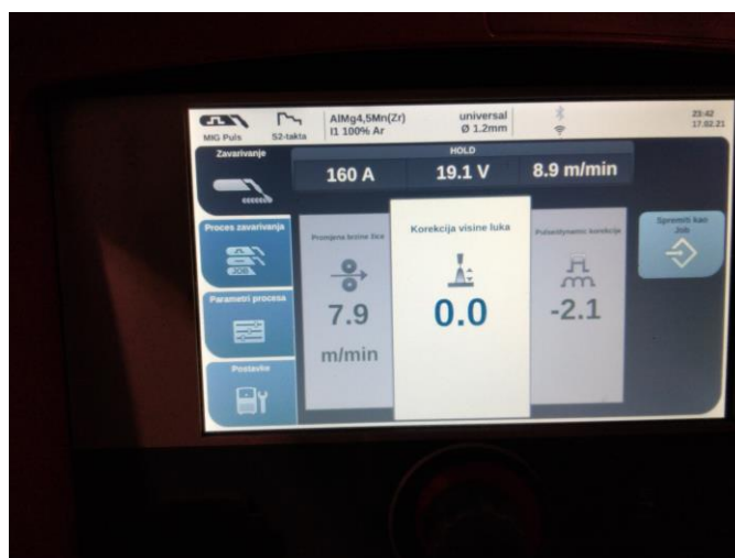
Slika 4.6 Podešavanje visine luka zavarivanja [21]
