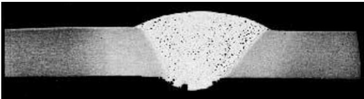
Slika 1.2 Prikaz fino raspršene poroznosti pri čeonom spoju aluminijskih debljine 6mm [4]
