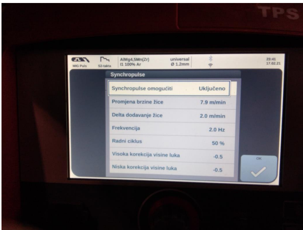
Slika 4.5 Prikaz omogućavanja synchropulse postupka [21]
