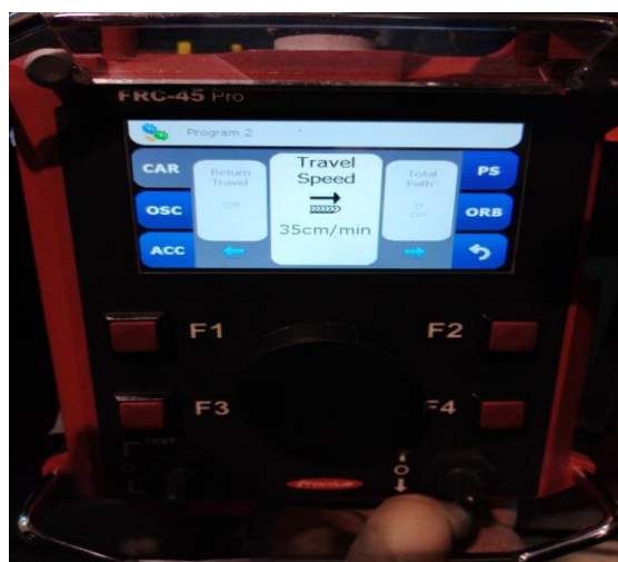
Slika 4.4 Podešavanje brzine zavarivanja [21]
