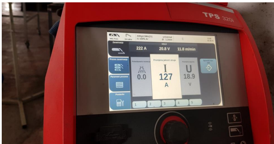
Slika 4.3 Prikaz promjene jakosti struje [21]
