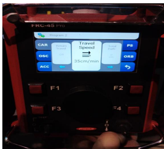
Slika 4.4 Podešavanje brzine zavarivanja [21]
