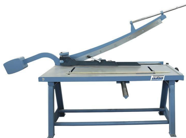
Slika 14. Nož za odsijecanje lima[12]
