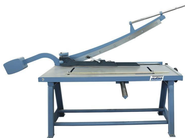
Slika 14. Nož za odsijecanje lima[12]
