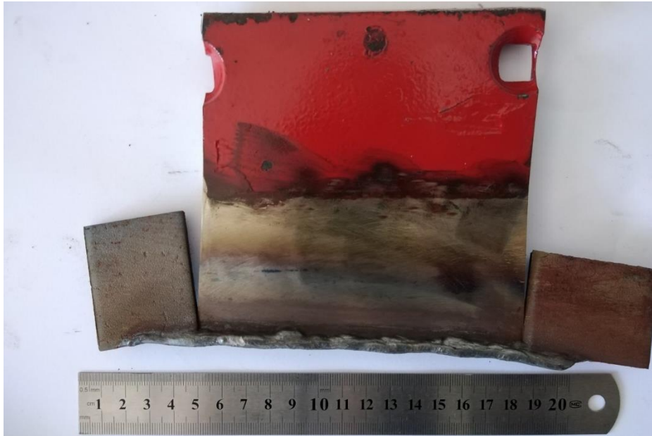
Slika 4.12 Prikaz navarenog novoga raonika
