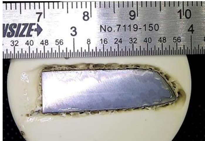
Slika 4.9 Prikaz potrošenog raonika
