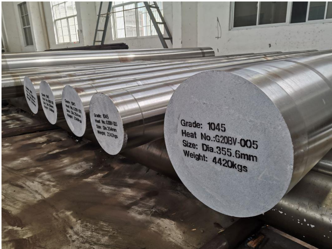
Slika 1.3 Prikaz početnog stanja čelika C45 [3]
