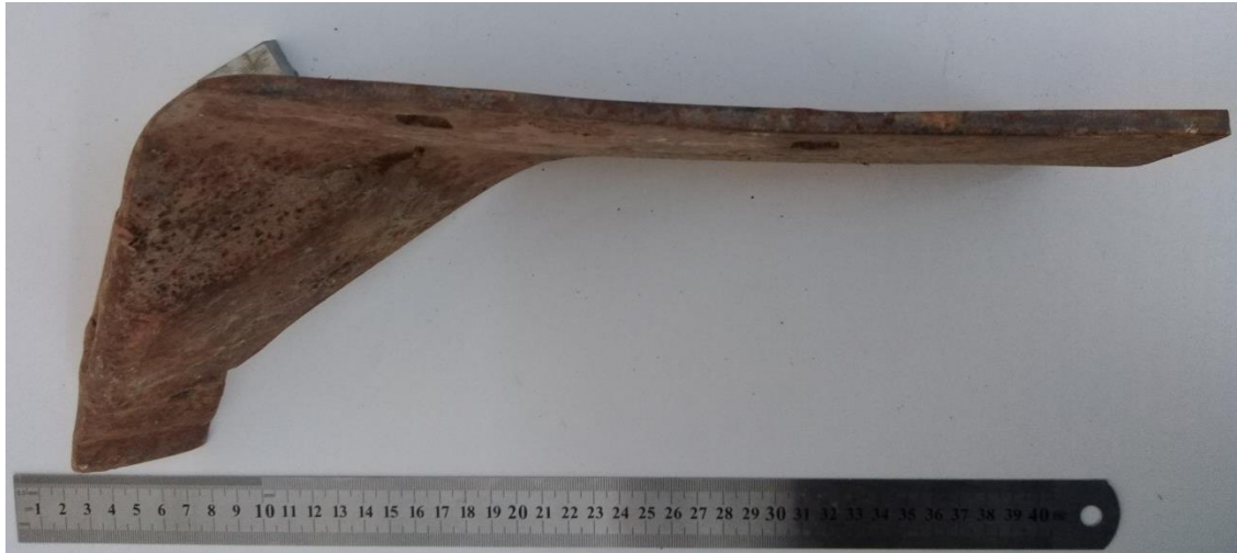
Slika 4.10 Prikaz potrošenog savijenog raonika
