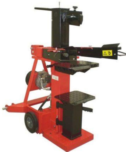
Slika 2.5 Stroj za cijepanje KARDANSKI 10 T – LS10 FATUR [5]
