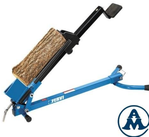
Slika 2.8 Ručni cijepač drva S015 1,2t Fervi [8]
