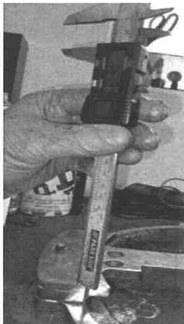
Slika 3.3 Mjerenje visine nosača
