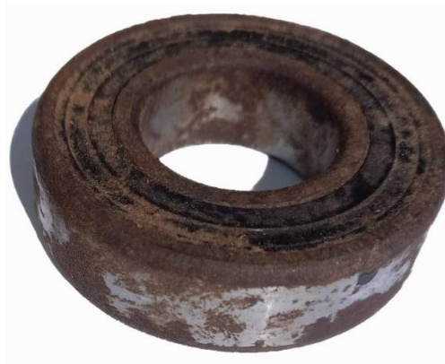
Slika 2.1 Korodirani klizni ležaj
