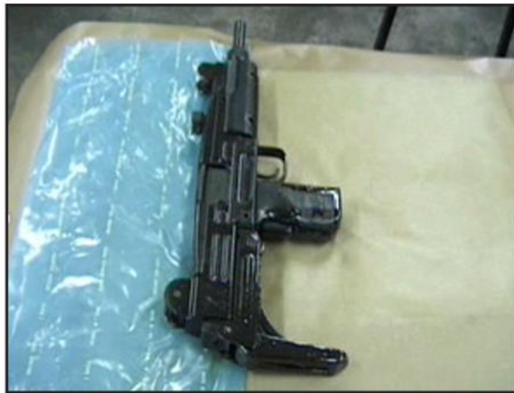
Slika 5.2 Konzervacija oružja VpCI folijom [9]
