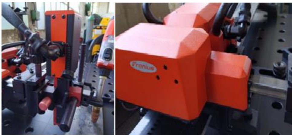
Slika 4.11 robot za pomak po z-osi (lijevo), robot za pomak po y-osi (desno) [1]
