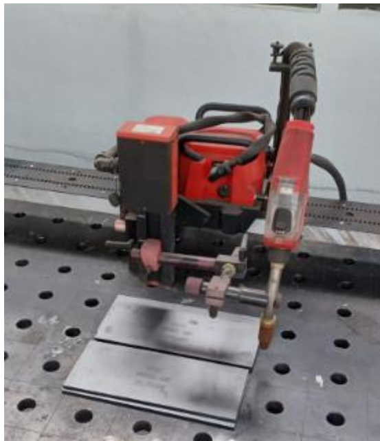
Slika 4.9 Traktor (automat) spreman za rad
