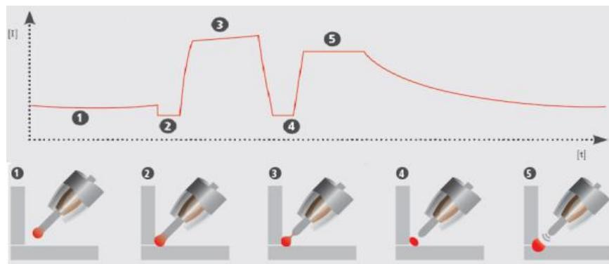
Slika 2.5 LSC prijenos metala kratkim spojem [1]
