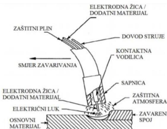
Slika 2.1 Shema MAG/MIG postupka zavarivanja [1]
