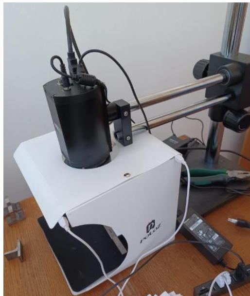
Slika 4.45 Auto fokus mjerni mikroskop
