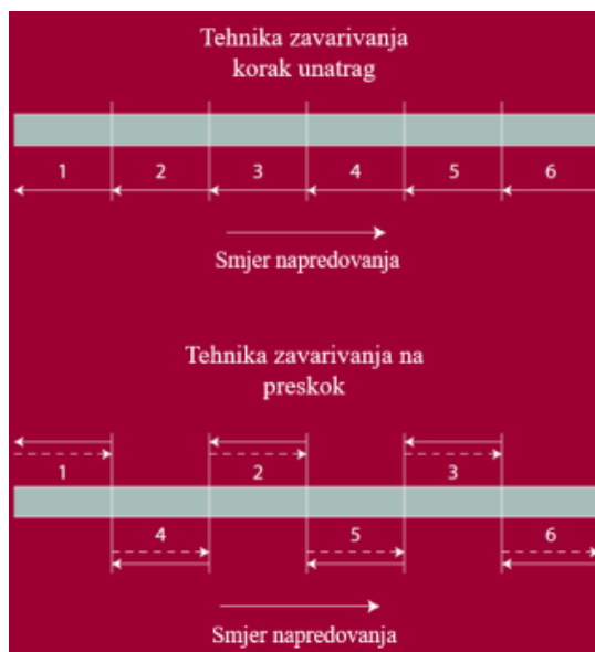
Slika 3.11 Smjer zavarivanja [6]
