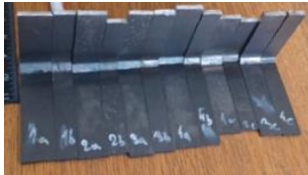
Slika 4.40 Izrezani ispitni uzorci
