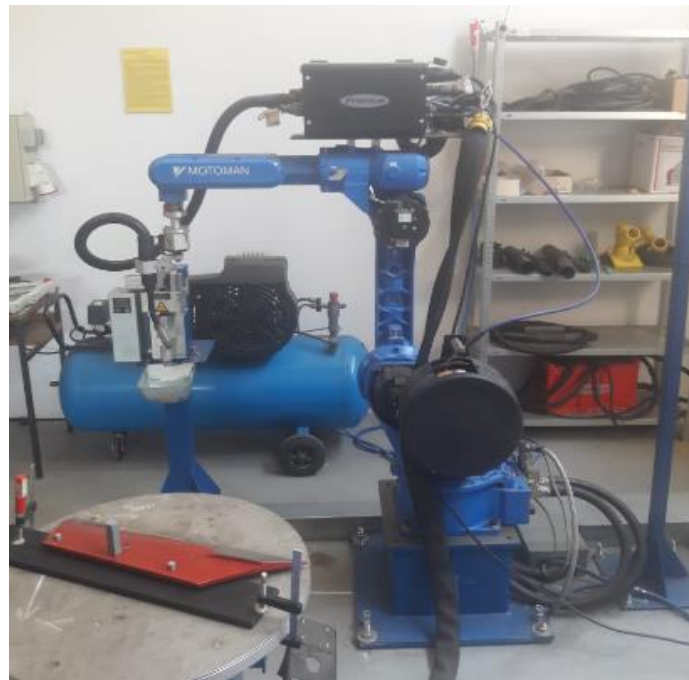
Slika 2.7 Robot za MIG/MAG zavarivanje [1]
