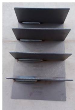
Slika 4.27 Ispitni uzorci nakon zavarivanja običnom žicom
