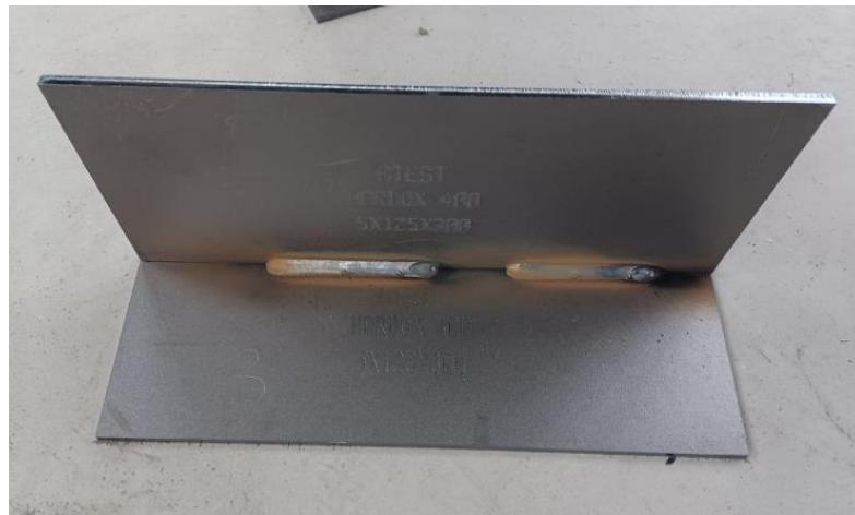
Slika 4.26 *Ispitni uzorak nakon zavarivanja*
