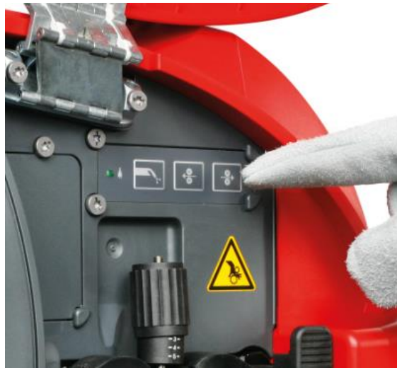
Slika 4.3 Prekidač za pomak dodatnog materijala [12]
