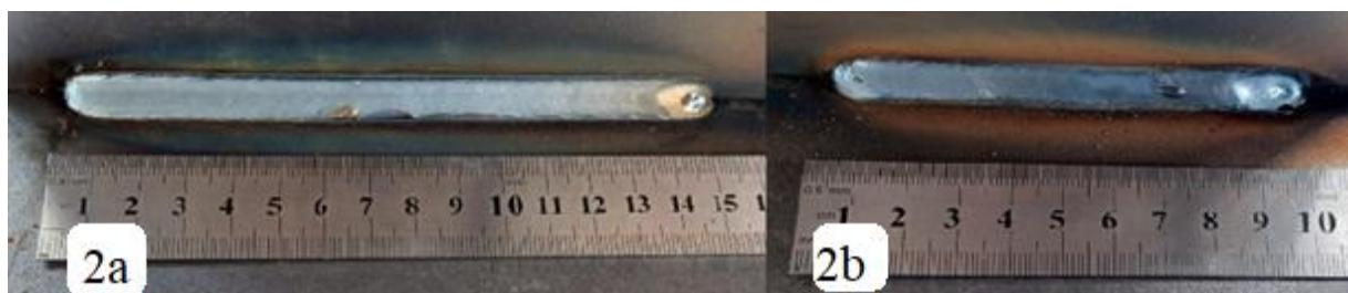
Slika 4.31 Ispitni uzorci: a-obična žica, b-praškom punjena žica za brzinu zavarivanja 20 cm/min
