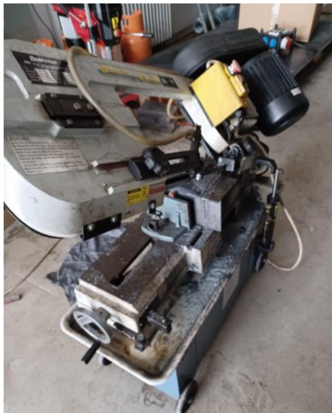
Slika 4.37 Izrezivanje prvog ispitnog uzorka
