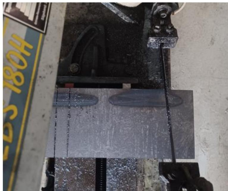
Slika 4.39 Rezanje drugog ispitnog uzorka
