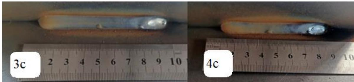
Slika 4.36 Ispitni uzorci praškom punjenom žicom za brzinu zavarivanja  $a = 25$  i
