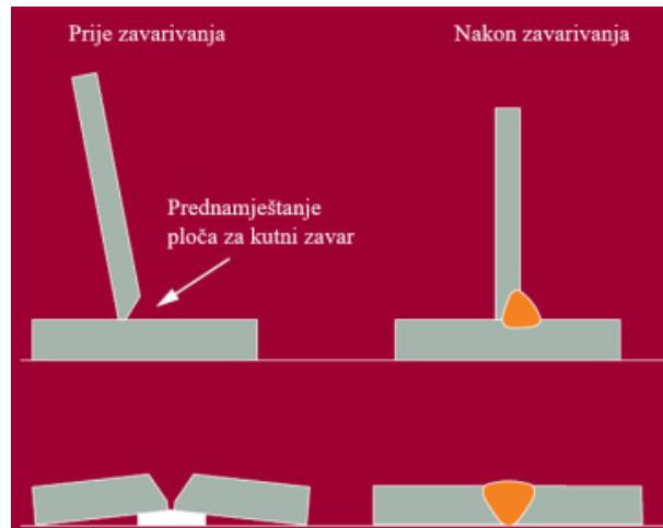
Slika 3.9 Pred namještanje komada koji se zavaruju [6]
