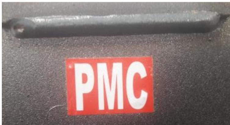
Slika 2.4 Izgled zavara PMC postupka [1]
