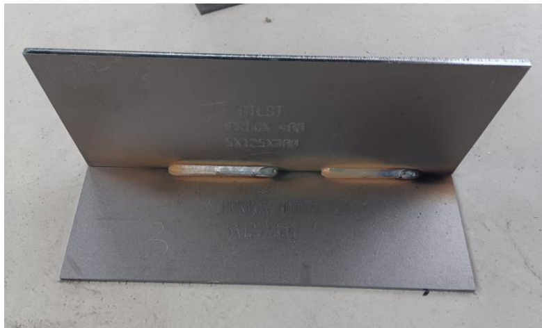
Slika 4.26 Ispitni uzorak nakon zavarivanja
