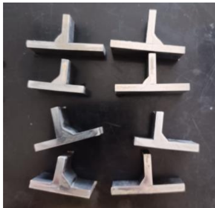
Slika 4.43 Obrušeni ispitni uzorci
