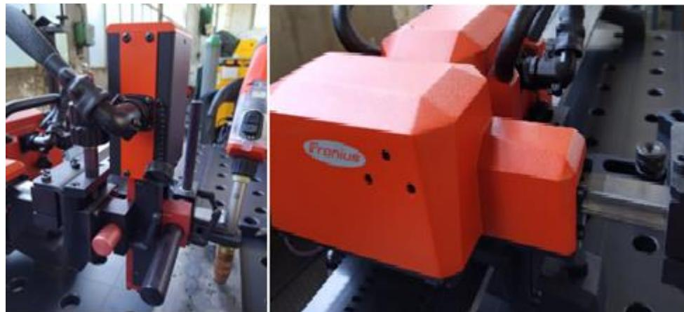
*Slika 4.11 robot za pomak po z-osi (lijevo), robot za pomak po y-osi (desno) [1]*
