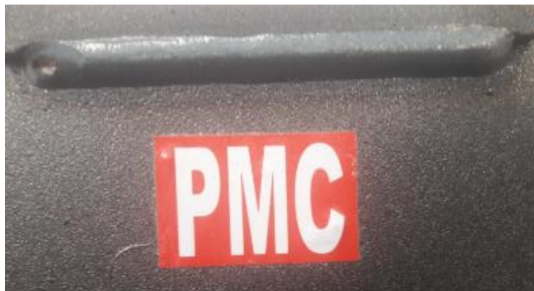
Slika 2.4 Izgled zavora PMC postupka [1]
