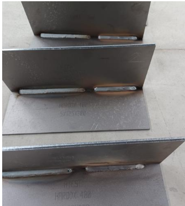
Slika 4.28 Ispitni uzorci nakon zavarivanja običnom žicom i praškom punjenom žicom
