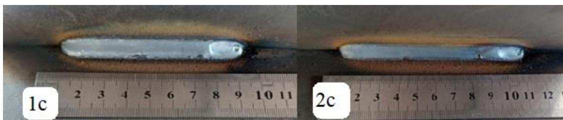
Slika 4.35 Ispitni uzorci praškom punjenom žicom za brzinu zavarivanja a = 15 i
