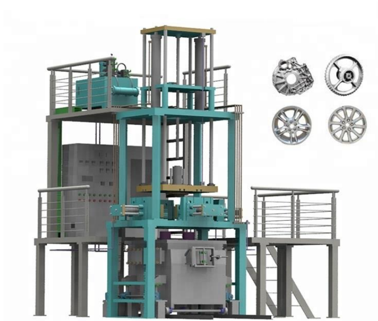
Slika 5.13 Stroj za lijevanje naplataka pod niskim tlakom [20]
