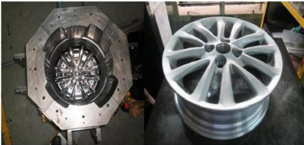
Slika 5.12 Naplatak izrađen gravitacijskim lijevanjem [19]
