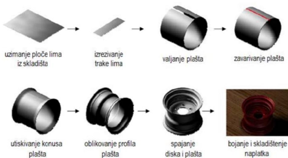
Slika 5.1 Shema tehnološkog procesa izrade čeličnog naplatka [14]
