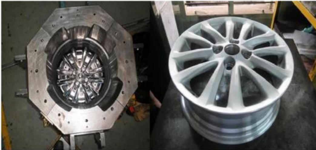
Slika 5.12 Naplatak izrađen gravitacijskim lijevanjem [19]
