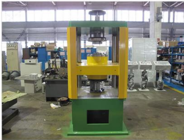
Slika 5.10 Pritisak diska u naplatak i zavarivanje [15]
