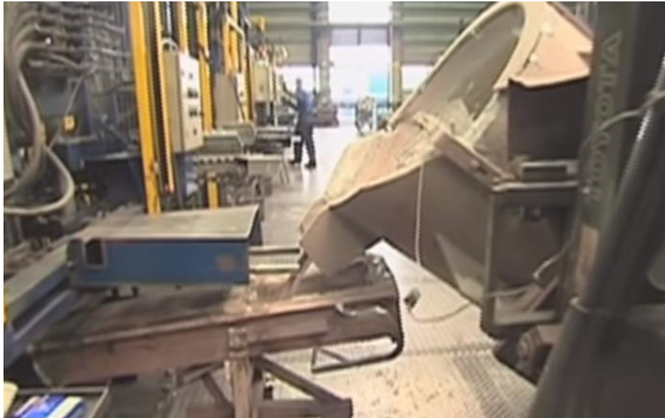
Slika 7.5 Izlivanje litine u kalup [22]
