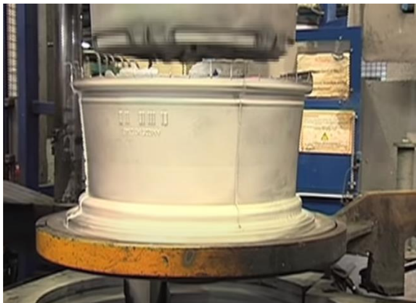
Slika 7.7 Naplatak izvađen iz kalupa [22]
