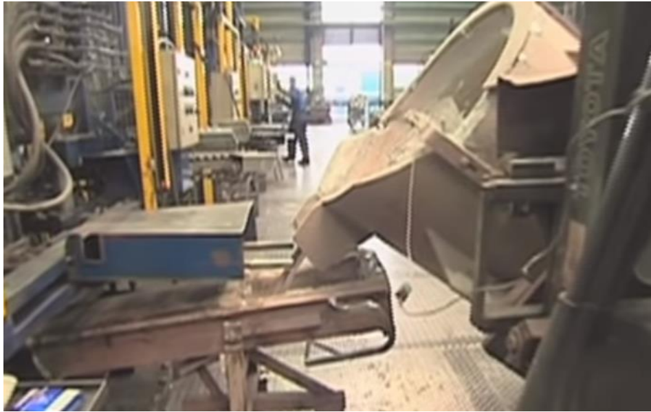
Slika 7.5 Izlivanje litine u kalup [22]
