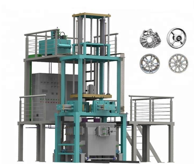
Slika 5.13 Stroj za lijevanje naplataka pod niskim tlakom [20]
