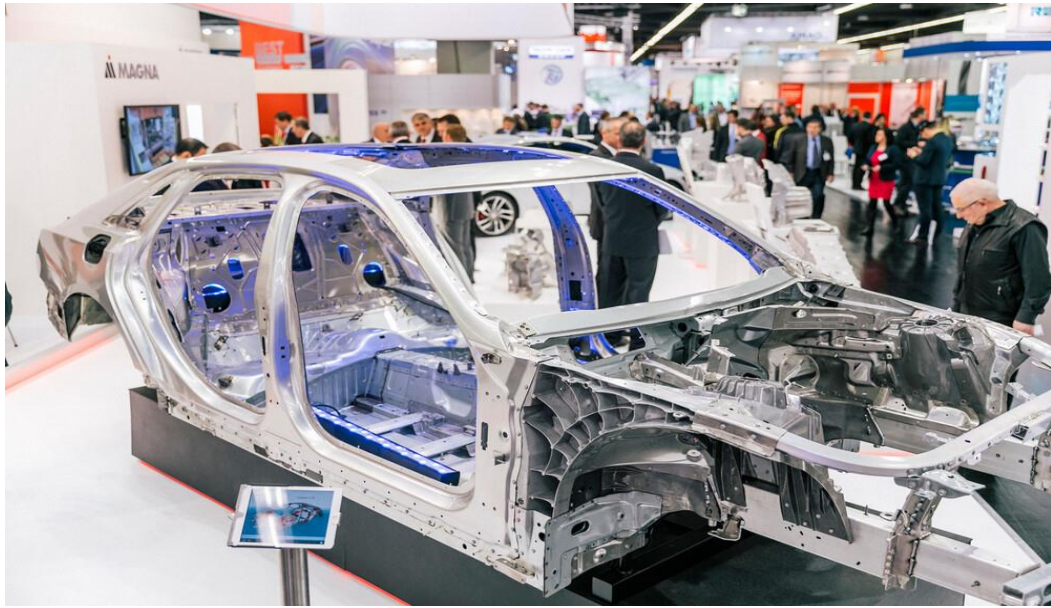
Slika 2.8 Dijelovi karoserija automobila izrađene tlačnim lijevom [8]
