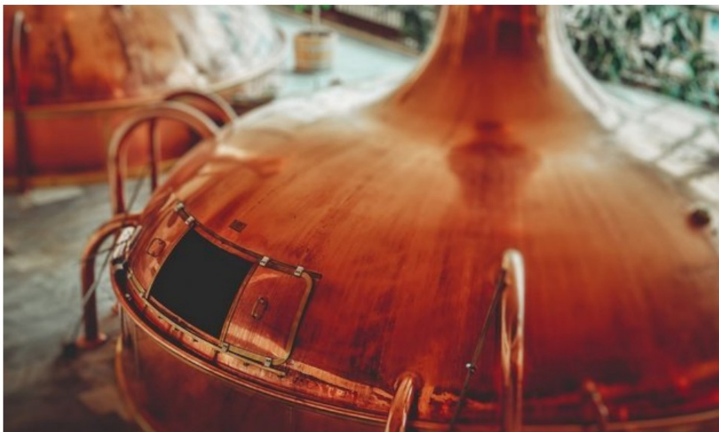
Slika 3.2 Kotao za kuhanje sladovine [17]
