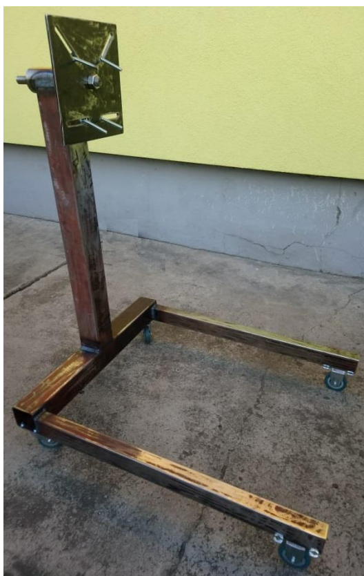
Figure 13. Zavarena izvedba nosača motora
