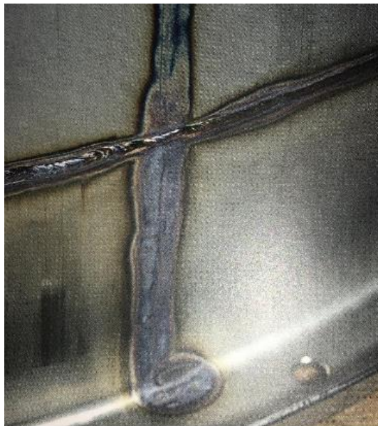
Slika 2.10 Pobojenost površine uzrokovana djelovanjem topline pri zavarivanju [16]
