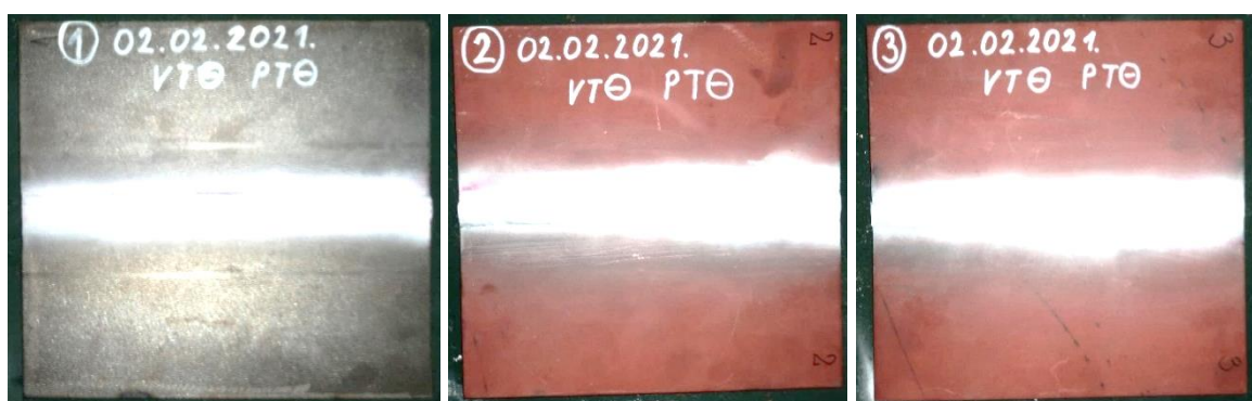
Slika 4.3 Izvješće o penetrantskom pregledu uzorka P1, P2, P3
