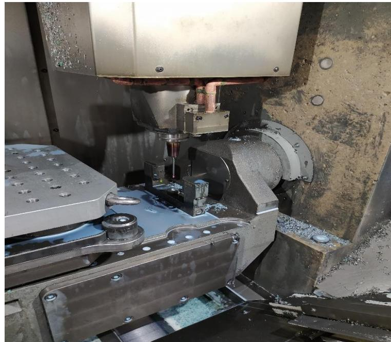
Slika 3.53 Umjeravanje alata [11]
