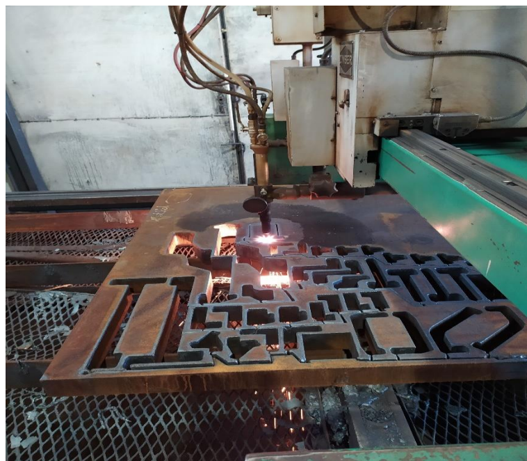
Slika 3.3 Plinsko izrezivanje na Zinser CNC 500/E [11]
