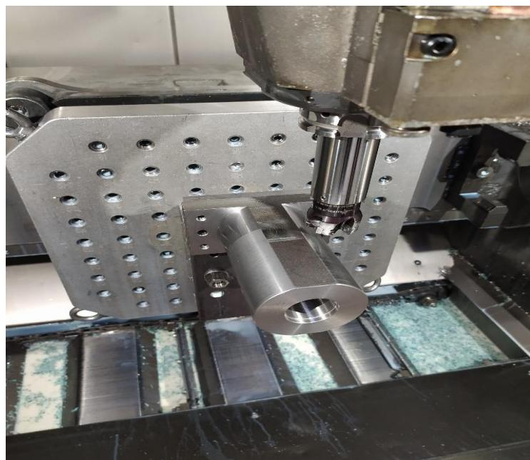
Slika 3.54 Fino glodanje površine s  $\phi 40\text{mm}$  [11]
