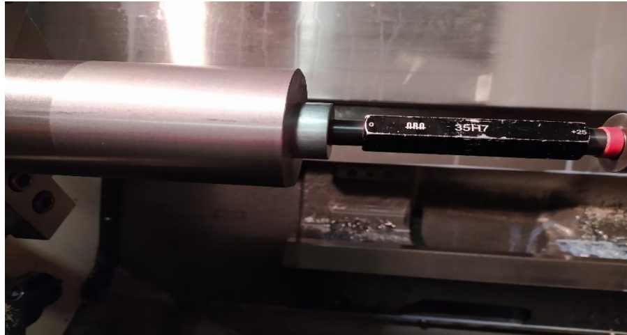
Slika 3.40 Kontrolni trn za \phi 35H7 [11]
