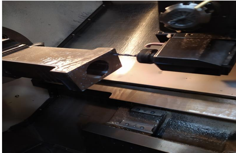
Slika 3.36 Bušenje provrta \text{fi}8\text{H}7 i \text{fi}9\text{mm} [11]
