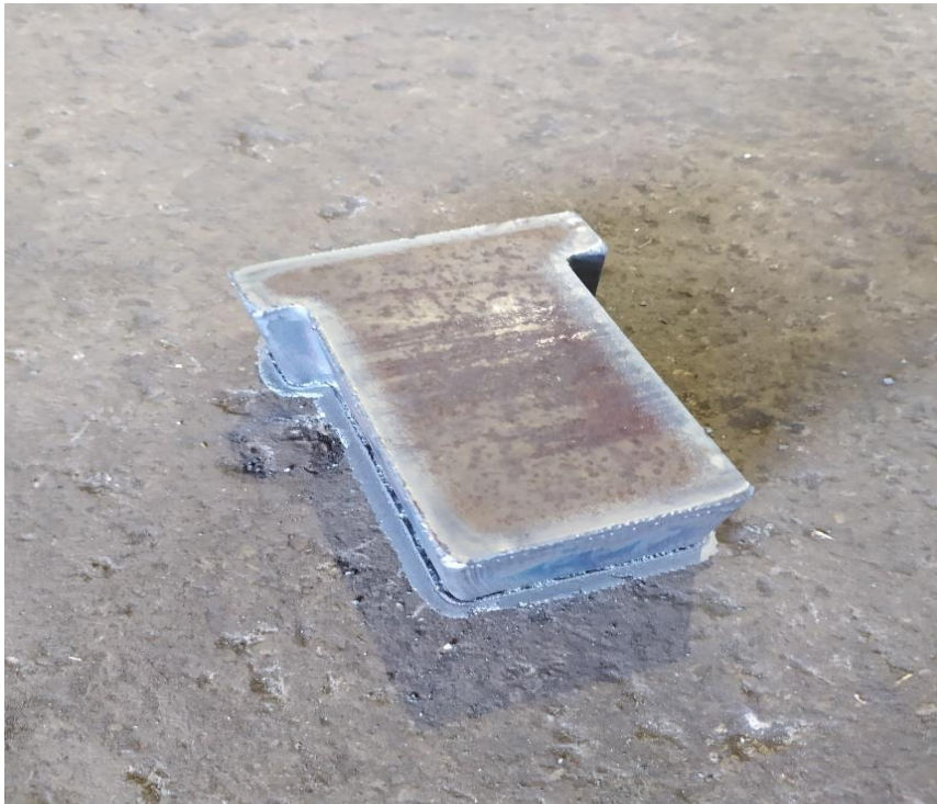
Slika 3.4 Sirovac nakog rezanja [11]
