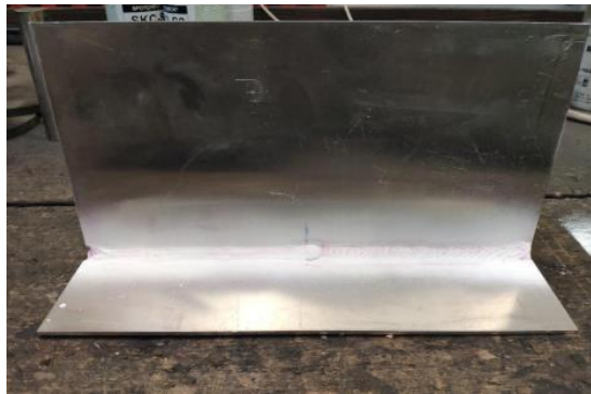
Slika 5.1 Prikaz zavarivanja nakon nanošenja penetranta [22]
