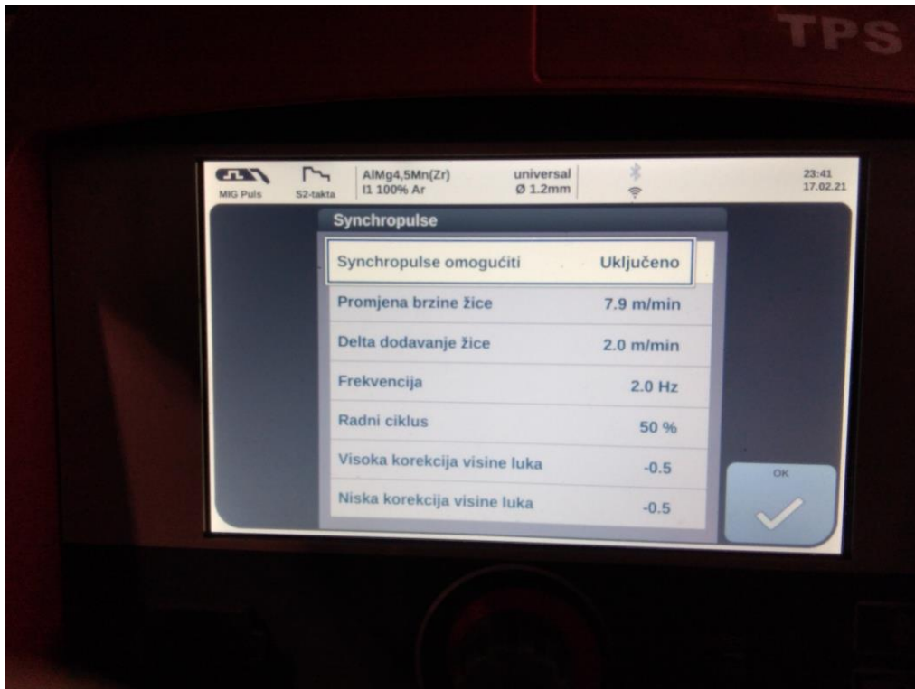
Slika 4.5 Prikaz omogućavanja synchropulse postupka [21]
