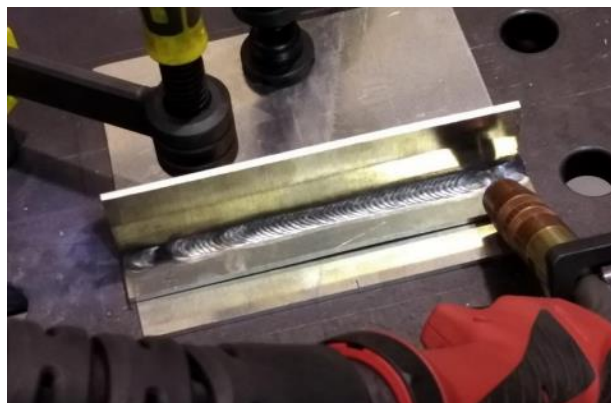
Slika 2.6 Zavar dobiven MIG synchro pulse zavarivanjem [16]
