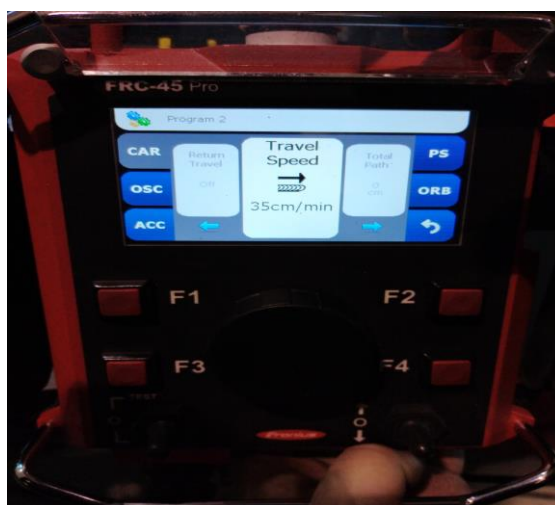
Slika 4.4 Podešavanje brzine zavarivanja [21]
