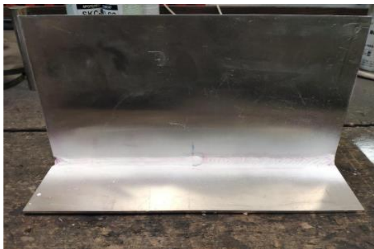
Slika 5.1 Prikaz zavarivanja nakon nanošenja penetranta [22]
