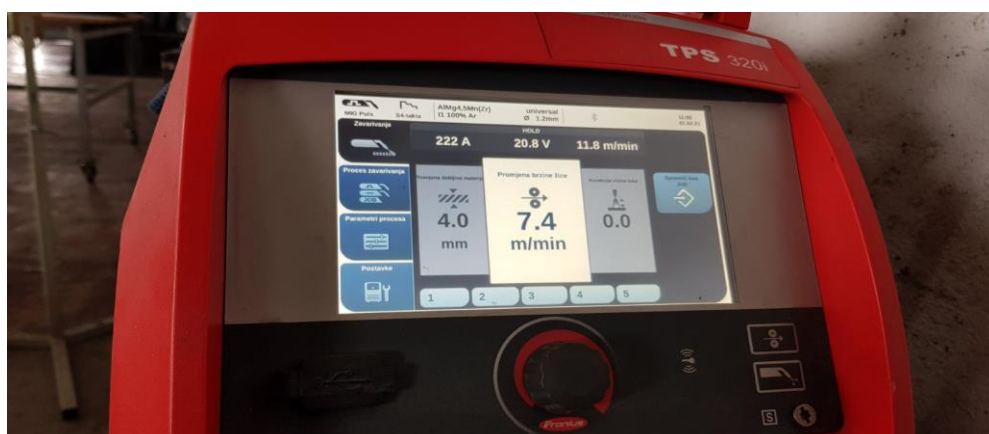
Slika 4.2 Promjena promjera žice za zavarivanje [21]
