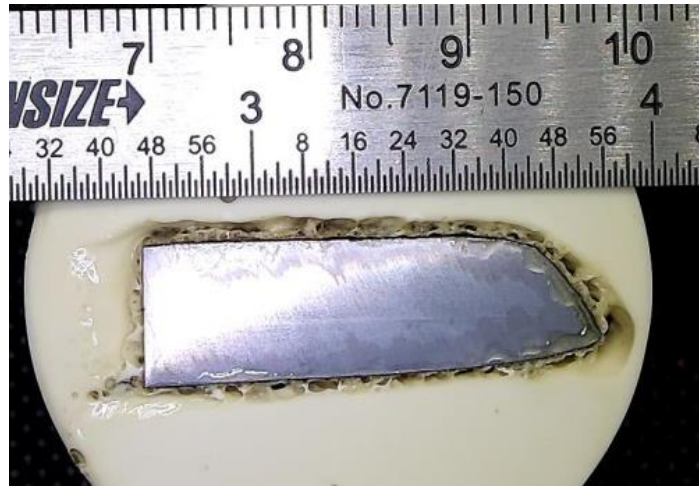
Slika 4.9 Prikaz potrošenog raonika
