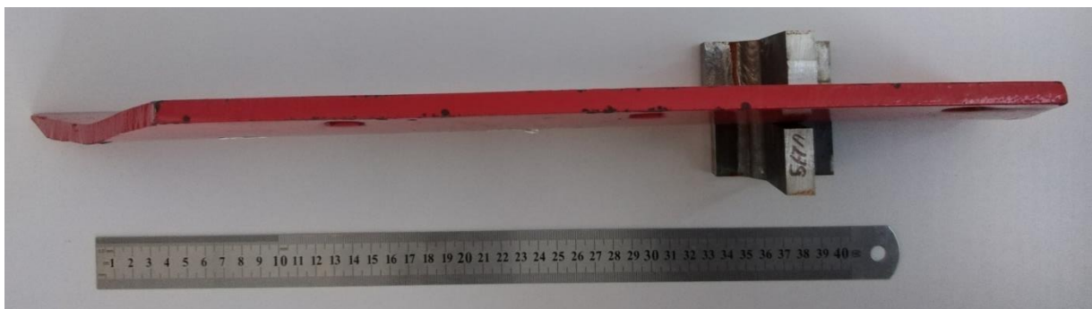
Slika 4.3 Prikaz uspravnog novoga raonika
