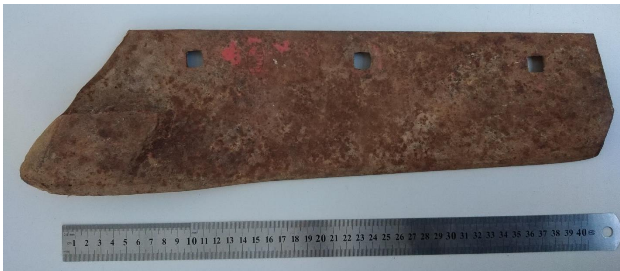
Slika 2.2 Prikaz potrošenog raonika
