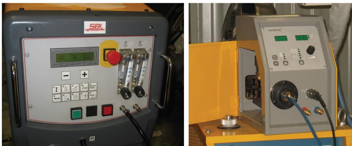
Slika 3.4 Izvor struje za plazma zavarivanje SBI 500 Varstroj s dodavačem žice [6]
