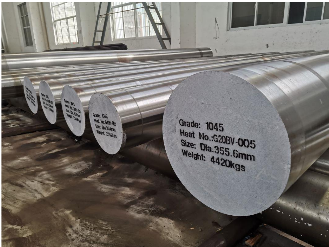
Slika 1.3 Prikaz početnog stanja čelika C45 [3]
