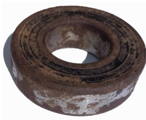
Slika 2.1 Korodirani klizni ležaj
