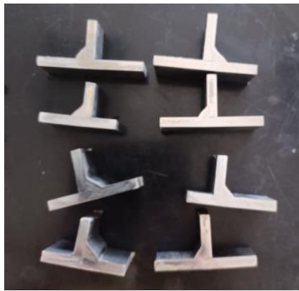
Slika 4.43 Obrušeni ispitni uzorci
