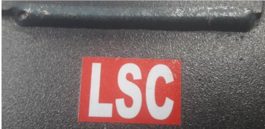
Slika 2.6 Zavareni spoj LSC postupkom [1]
