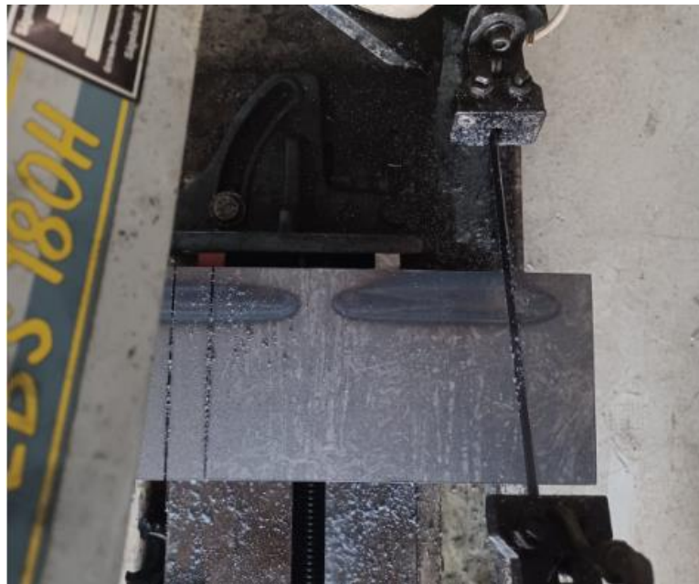
Slika 4.39 Rezanje drugog ispitnog uzorka
