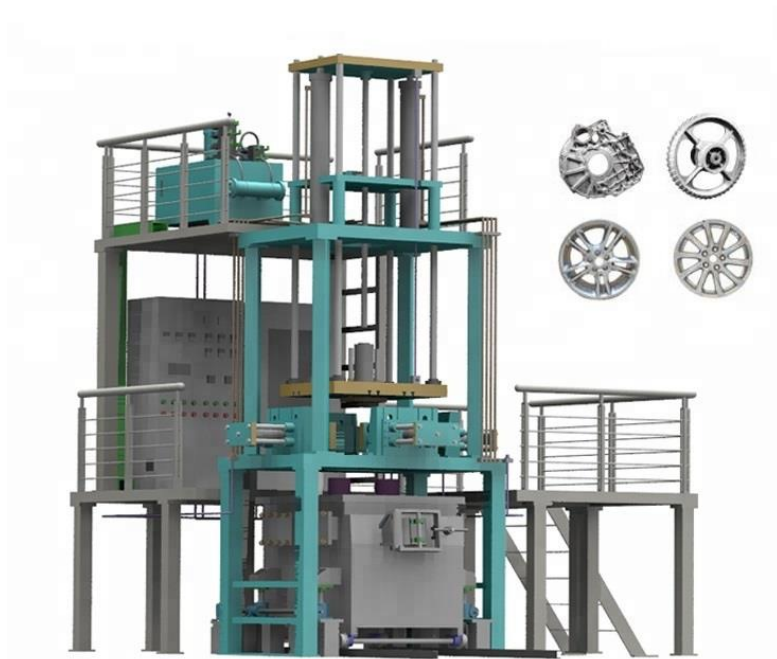
Slika 5.13 Stroj za lijevanje naplataka pod niskim tlakom [20]
