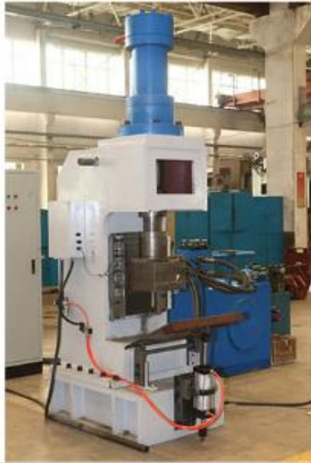
Slika 5.9 Testiranje nepropusnosti plina i probijanje rupe za ventil [15]
