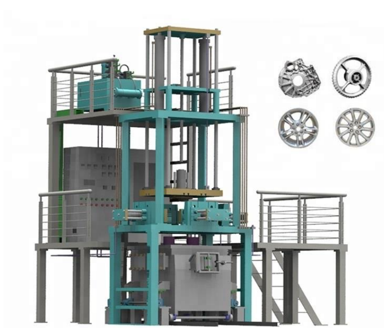
Slika 5.13 Stroj za lijevanje naplataka pod niskim tlakom [20]
