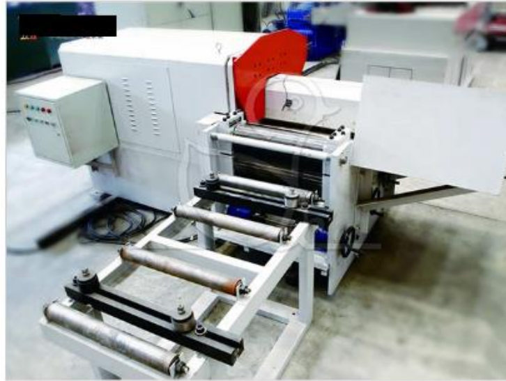
Slika 5.3 Priprema, zaglađivanje i utiskivanje oznake [15]
