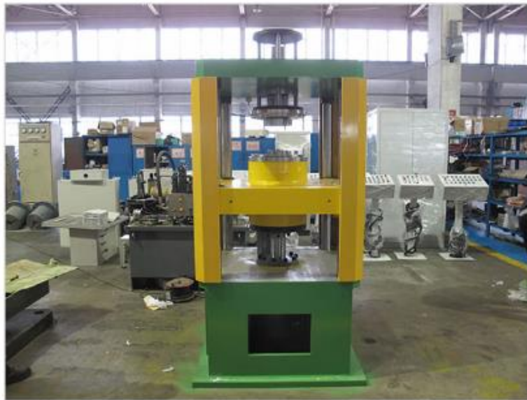
Slika 5.10 Pritisak diska u naplatak i zavarivanje [15]
