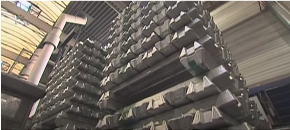
Slika 7.1 Ingoti za taljenje [22]
