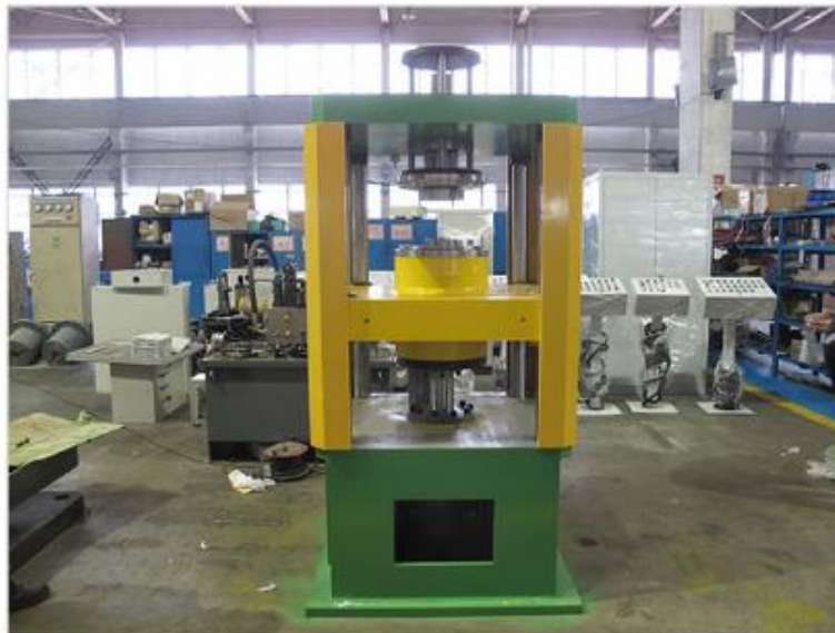
Slika 5.10 Pritisak diska u naplatak i zavarivanje [15]
