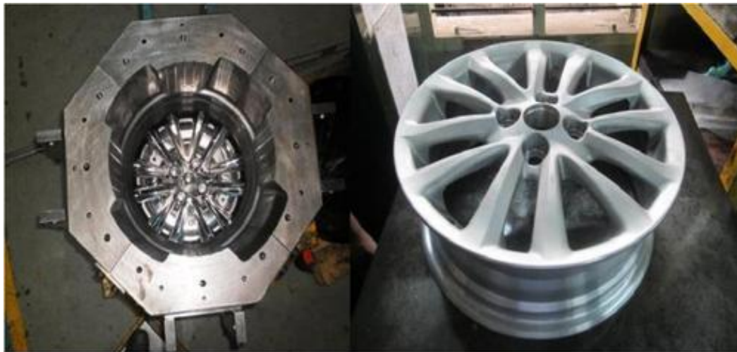
Slika 5.12 Naplatak izrađen gravitacijskim lijevanjem [19]
