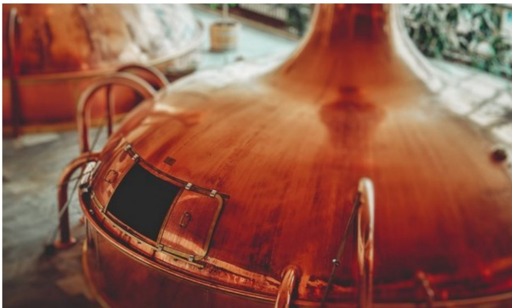
Slika 3.2 Kotao za kuhanje sladovine [17]
