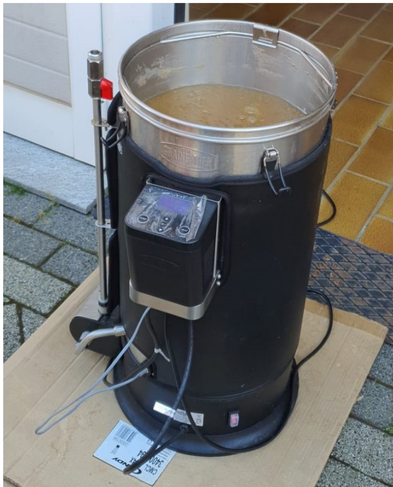
Slika 5.2 Uređaj za proizvodnju piva „Grainfather G30“ [32]
