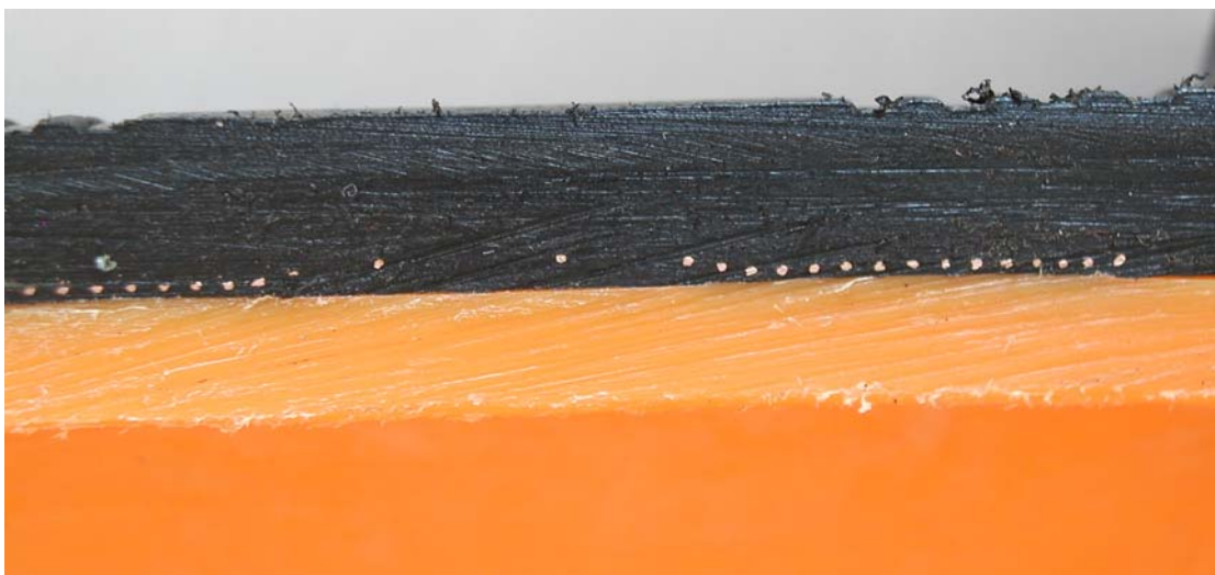
Slika 6. Detalj elektrofuzijskog zavarenog spoja u presjeku
