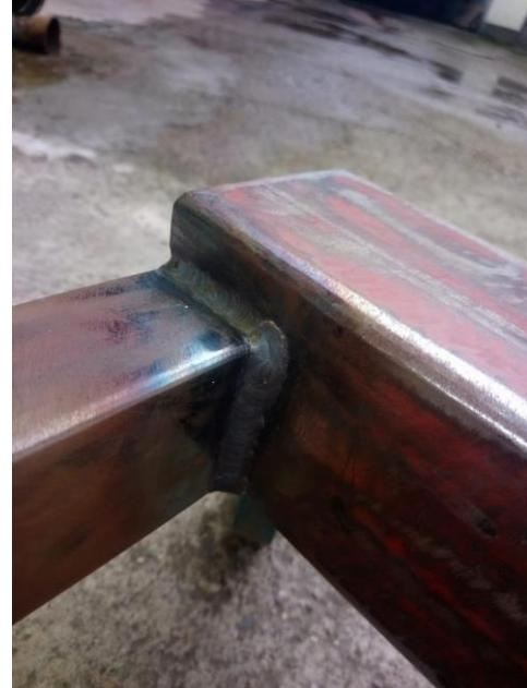
Figure 12. Zavar cijevi postolja
