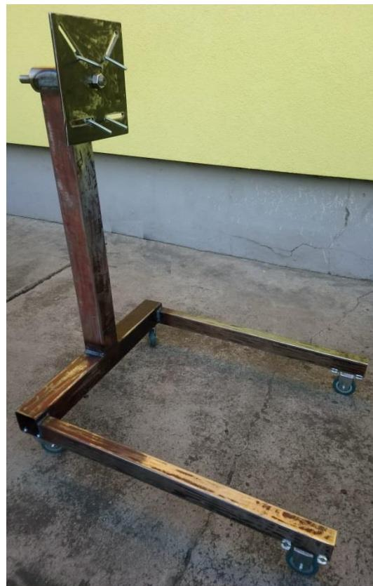
Figure 13. Zavarena izvedba nosača motora
