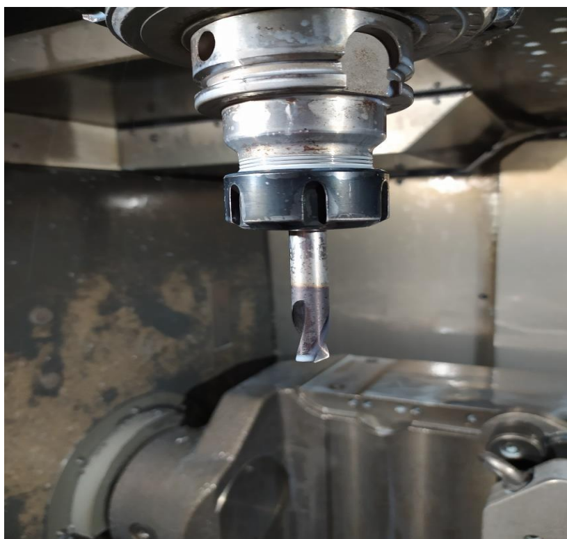
Slika 3.56 Zabušivač Garant 12mm 142stp [11]
