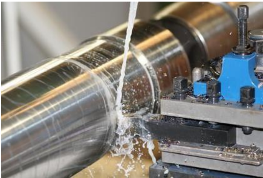
Slika 1.15 Tokarenje s vanjskom primjenom SHIP-a [7]
