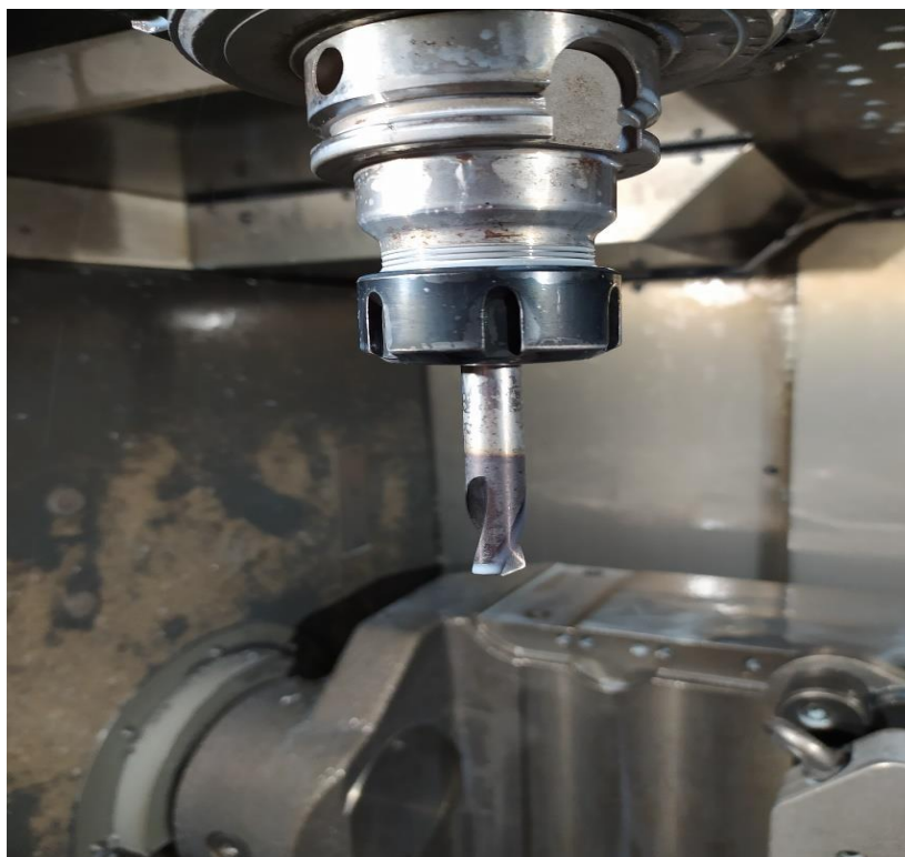
Slika 3.56 Zabušivač Garant 12mm 142stp [11]
