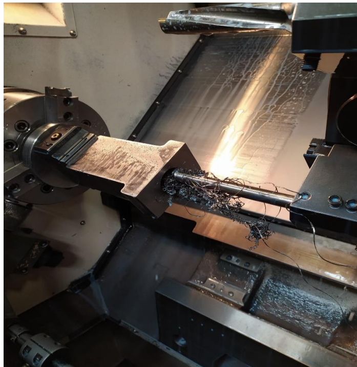
Slika 3.35 Tokarski nož za unutarnje tokarenje S32U PCLNR12 L=125 [11]
