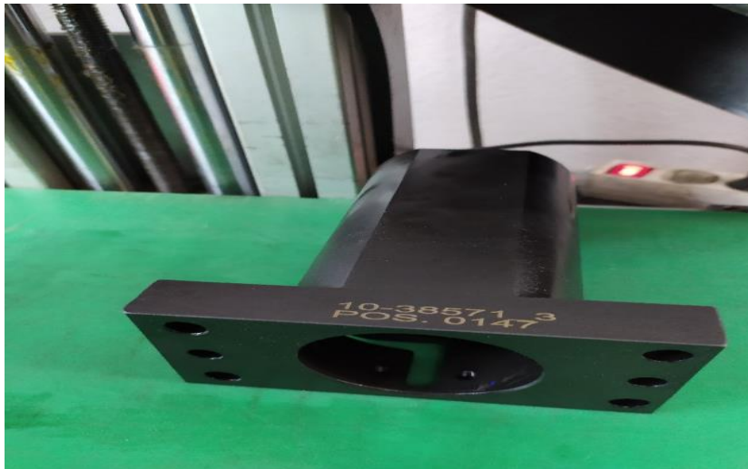
Slika 3.63 Lasersko gravinje serijskog broja pozicije [11]
