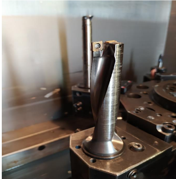
Slika 3.34 Svrđlo KOMET \varnothing 28\text{mm} [11]
