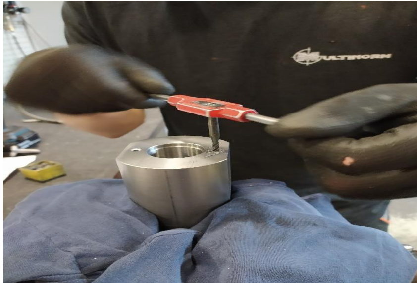
Slika 3.59 Ručno urezivanje navoja M5 prema crtežu [11]
