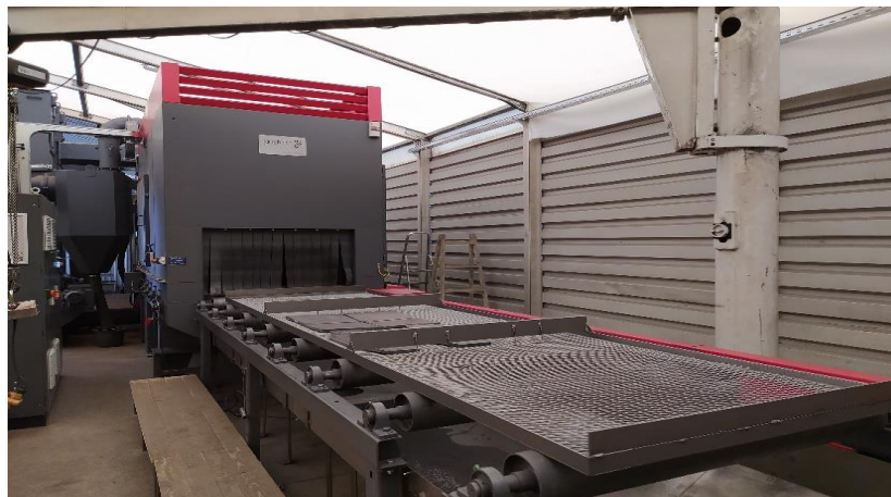
Slika 3.5 Gostol tip 1000x600 za sačmarenje [11]
