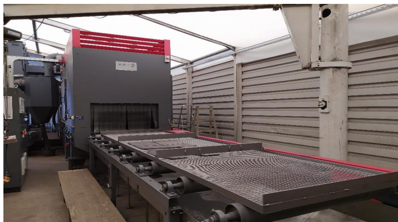
Slika 3.5 Gostol tip 1000x600 za sačmarenje [11]
