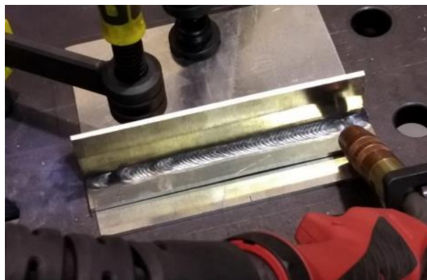
Slika 2.6 Zavar dobiven MIG synchro pulse zavarivanjem [16]
