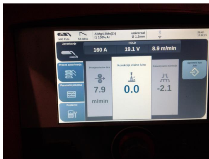
Slika 4.6 Podešavanje visine luka zavarivanja [21]
