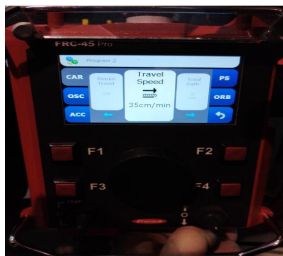
Slika 4.4 Podešavanje brzine zavarivanja [21]
