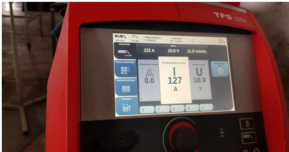
Slika 4.3 Prikaz promjene jakosti struje [21]
