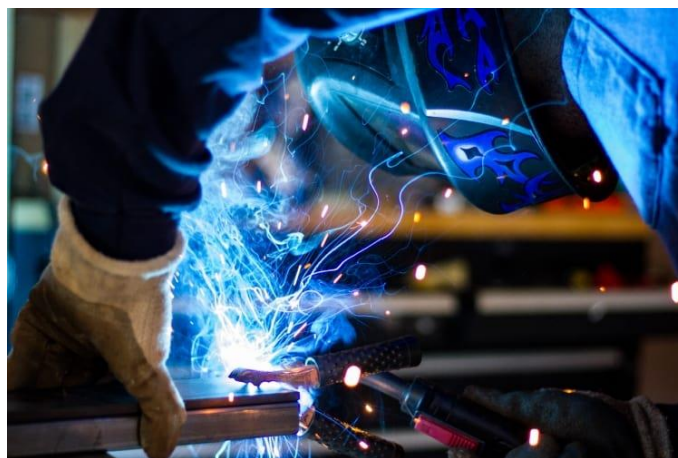
Slika 3.3 Prikaz FCAW metode zavarivanja [5]
