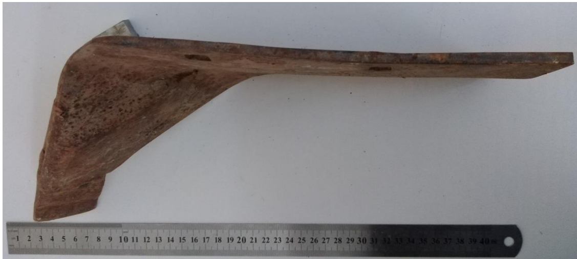
Slika 4.10 Prikaz potrošenog savijenog raonika
