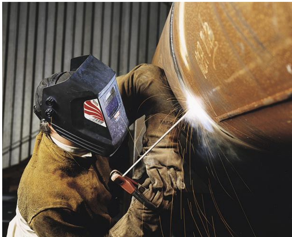
Slika 4.1 Prikaz REL tehnologije zavarivanja [10]
