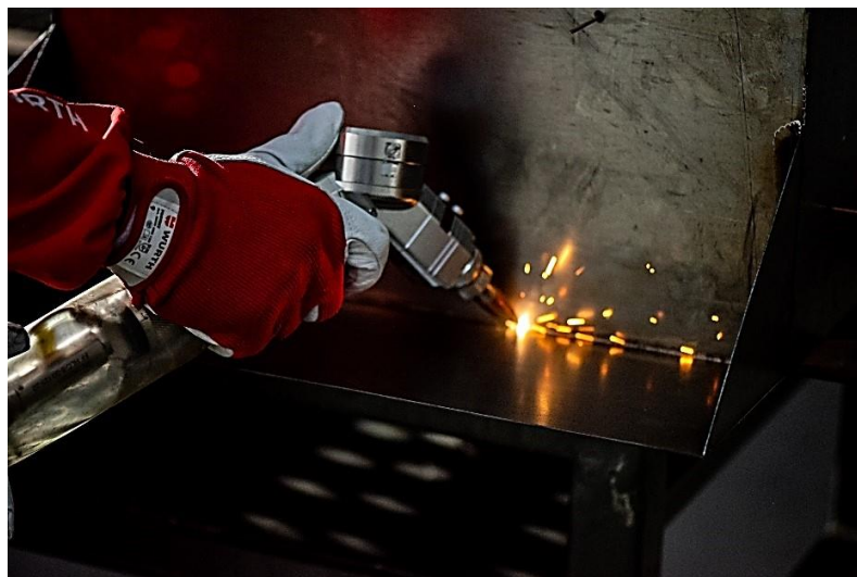
Slika 3.6 Prikaz laserskog zavarivanja
