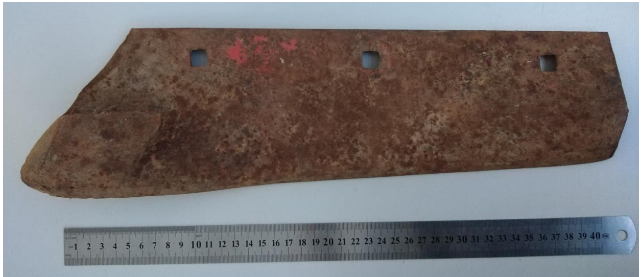
Slika 2.2 Prikaz potrošenog raonika
