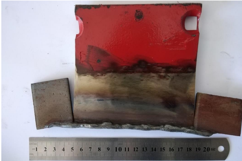
Slika 4.12 Prikaz navarenog novoga raonika
