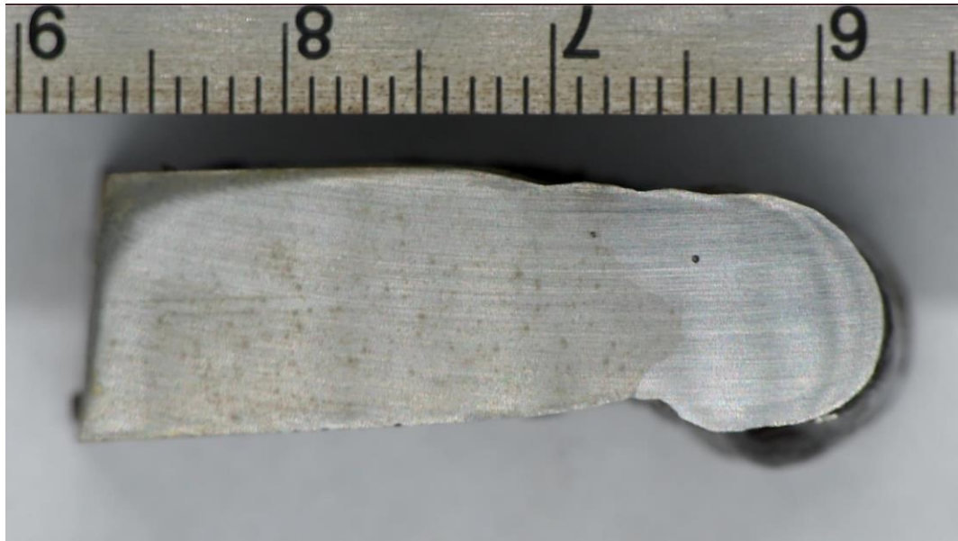
Slika 4.15 Prikaz potrošenog raonika navarenog E-DUR 600 elektrodom
