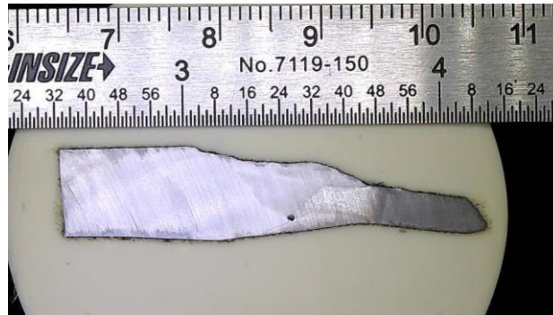
Slika 4.11 Prikaz zavarenog raonika
