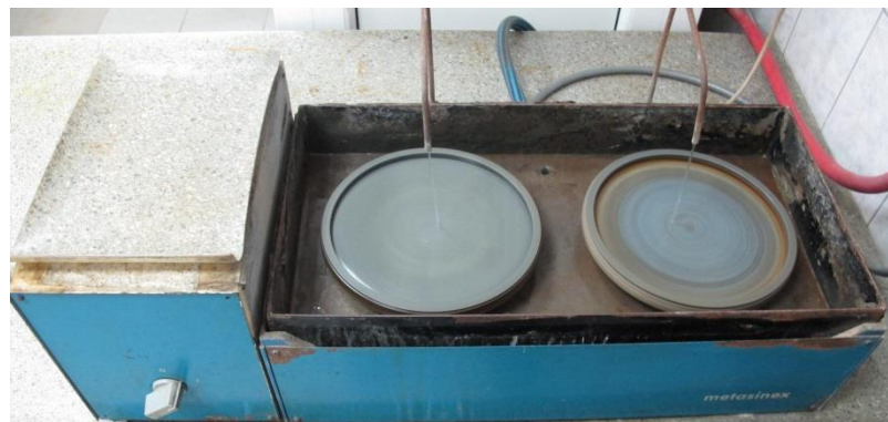
Slika 4.7 Prikaz stroja za poliranje [13]
