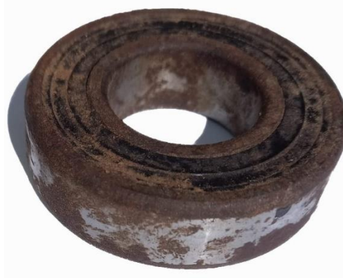
Slika 2.1 Korodirani klizni ležaj
