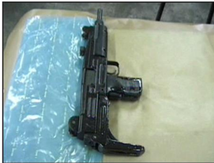
Slika 5.2 Konzervacija oružja VpCI folijom [9]
