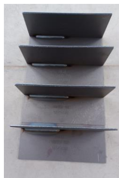
Slika 4.27 Ispitni uzorci nakon zavarivanja običnom žicom
