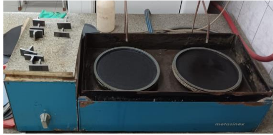
Slika 4.42 Uređaj za brušenje uzoraka
