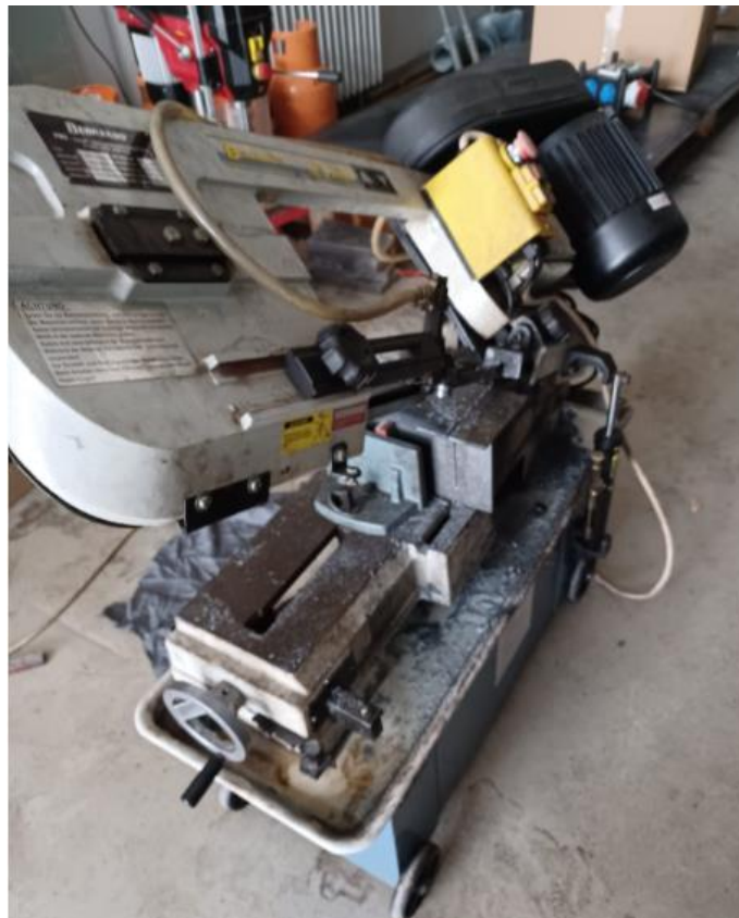
Slika 4.37 Izrezivanje prvog ispitnog uzorka
