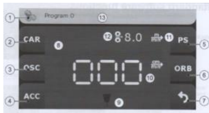
Slika 4.8. Displej i kotačić za podešavanje [1]
