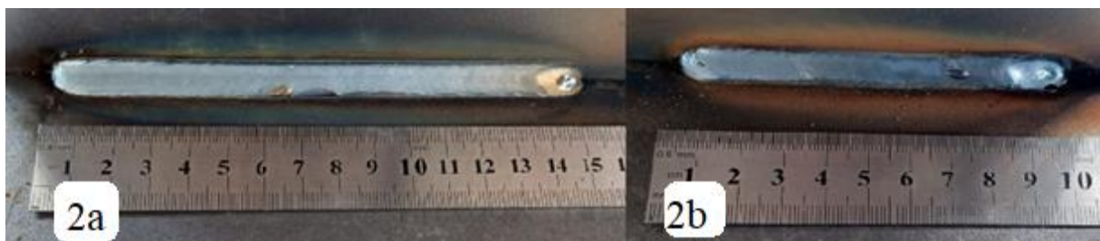
Slika 4.31 Ispitni uzorci: a-obična žica, b-praškom punjena žica za brzinu zavarivanja 20 cm/min
