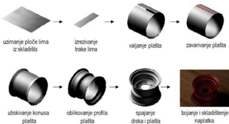
Slika 5.1 Shema tehnološkog procesa izrade čeličnog naplatka [14]
