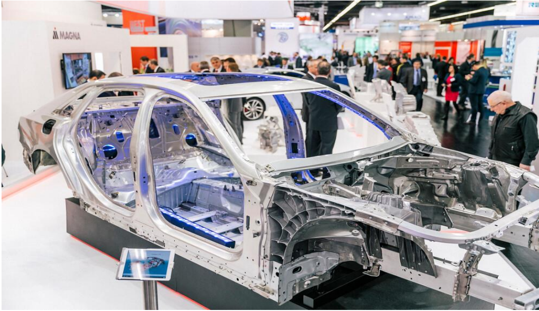
Slika 2.8 Dijelovi karoserija automobila izrađene tlačnim lijevom [8]
