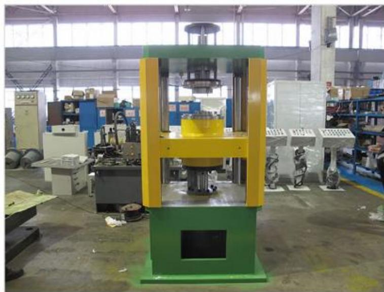
Slika 5.10 *Pritisak diska u naplatak i zavarivanje* [15]
