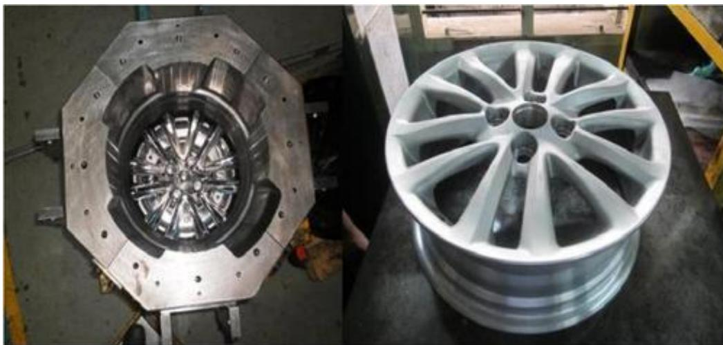
Slika 5.12 Naplatak izrađen gravitacijskim lijevanjem [19]
