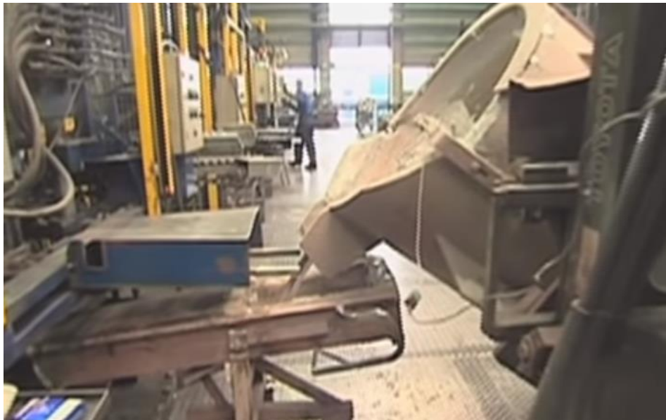
Slika 7.5 Izlivanje litine u kalup [22]
