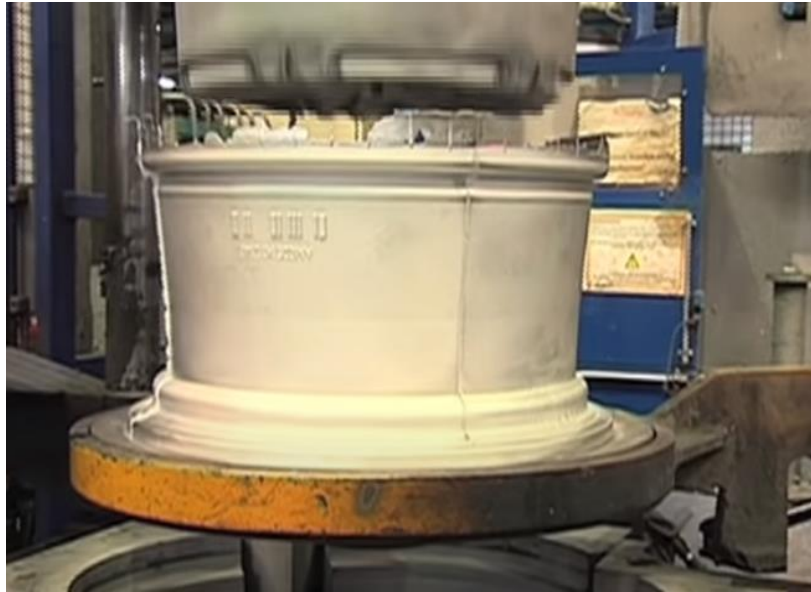
Slika 7.7 Naplatak izvađen iz kalupa [22]
