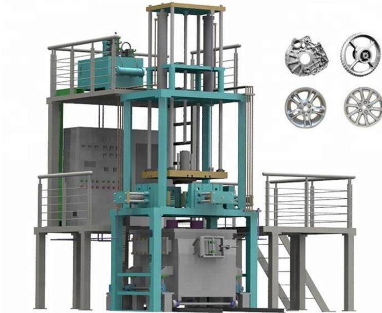
Slika 5.13 Stroj za lijevanje naplataka pod niskim tlakom [20]
