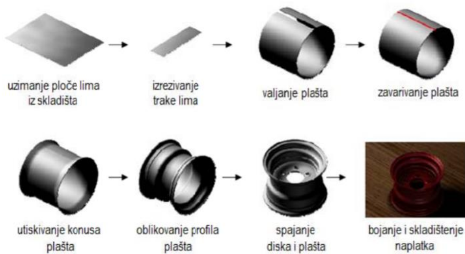
Slika 5.1 Shema tehnološkog procesa izrade čeličnog naplatka [14]
