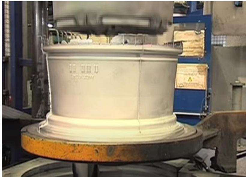
*Slika 7.7 Naplatak izvaden iz kalupa [22]*
