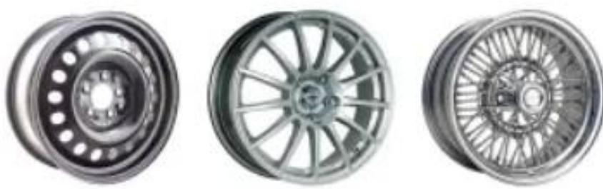
Slika 3.1 Čelični, aluminijski i žbičani naplatak [10]
