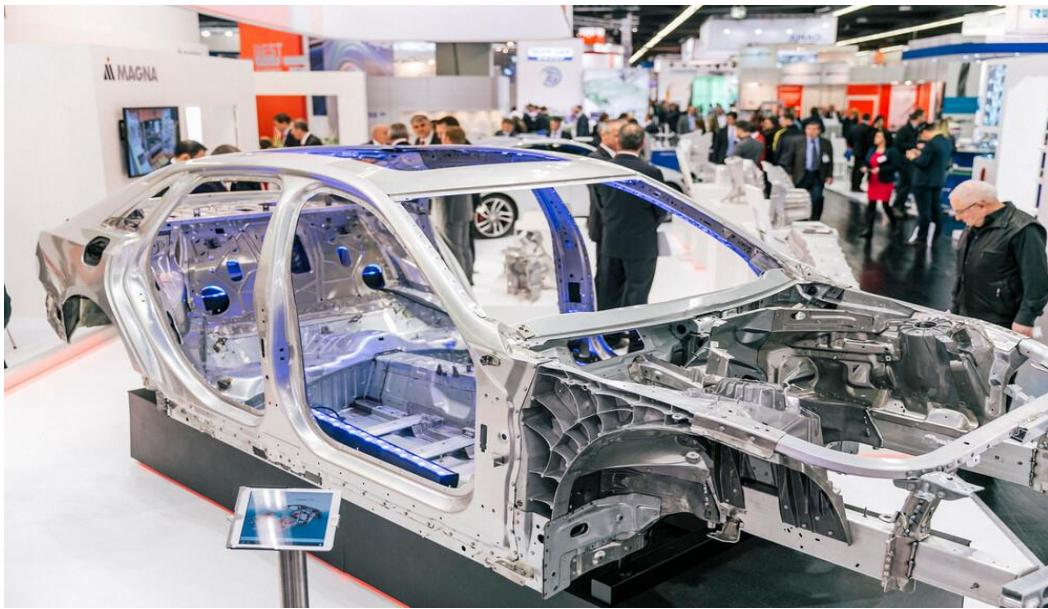
Slika 2.8 Dijelovi karoserija automobila izrađene tlačnim lijevom [8]
