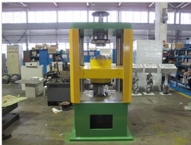
Slika 5.10 Pritisak diska u naplatak i zavarivanje [15]
